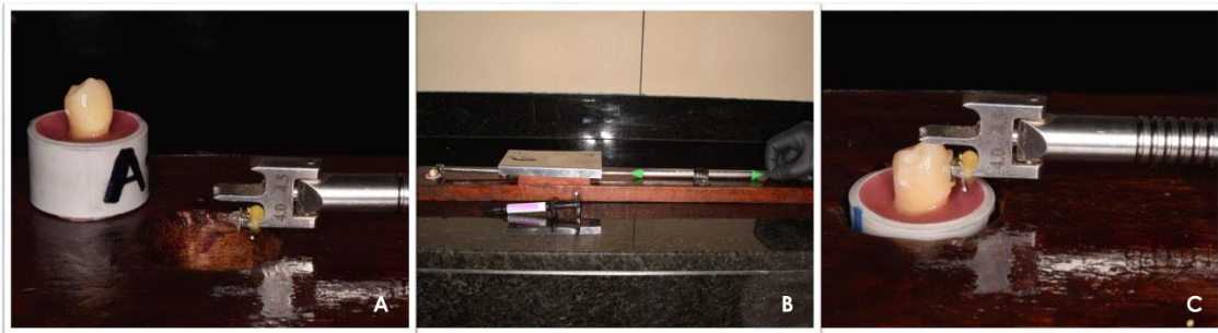
Figura 10. A. Colocación del bracket en el posicionador Morelli, se añade cemento a la malla del bracket. B. Se ejerció una presión de 200 g con el dinamómetro Dental Morelli MR. C. Acercamiento de la base del bracket a la superficie del esmalte.
