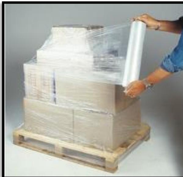
Ilustración 27. Paletización con Stretch Film
