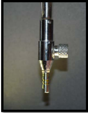
Foto 5. Pilar y análogo colocados en soporte del paralelógrafo.
