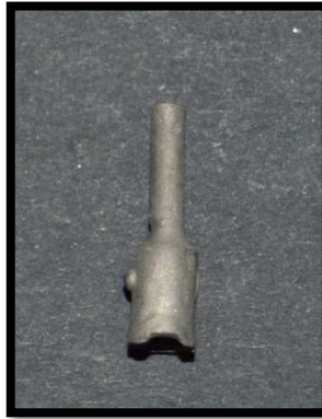
Foto 11. Cofia con ranura de dislocamiento
