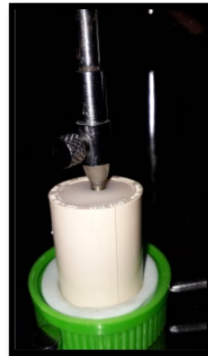
Foto 7 y 8. Inserción del pilar con análogo dentro del cilindro.
