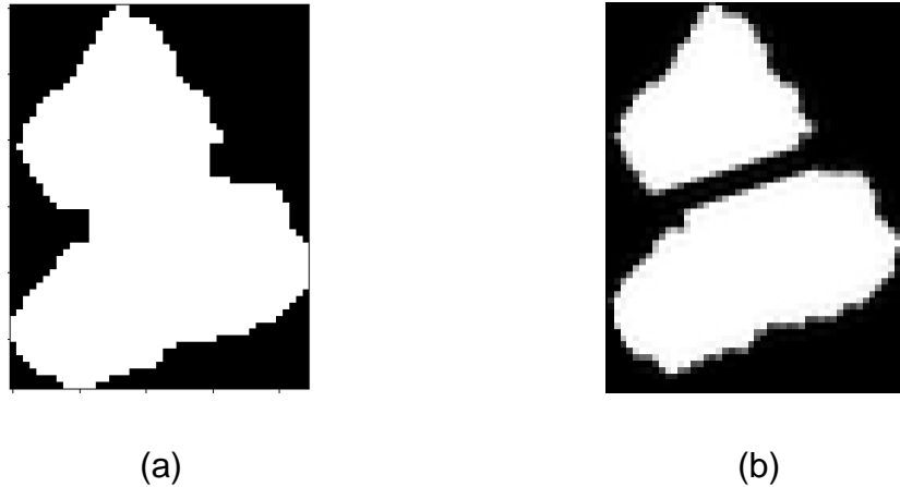
Figura 39. Resultados de la separación de células (a) Células juntas (b) Células separadas por el algoritmo propuesto Elaboración: los autores
