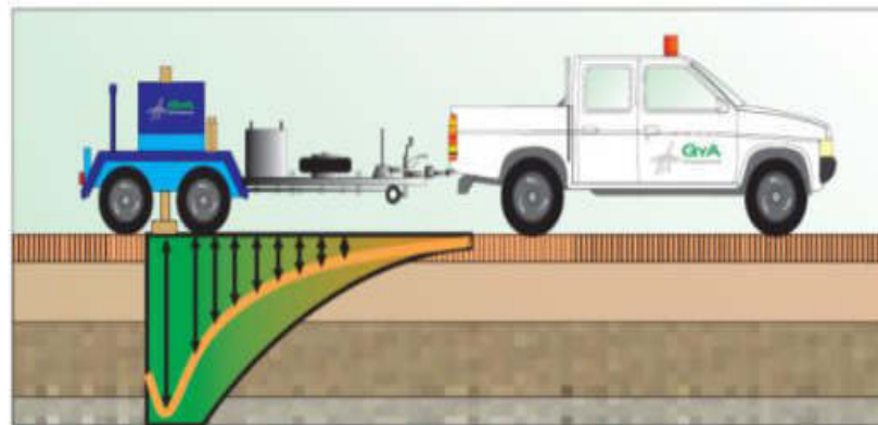
Figura 19. Evaluación del pavimento por Deflectómetro de impacto
