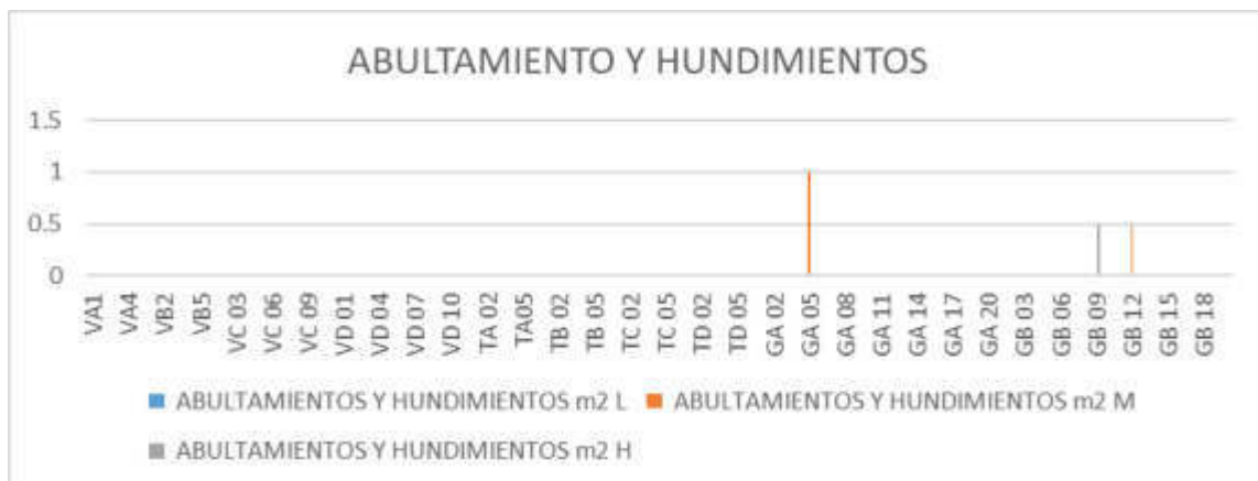
Figura 76. Distribución de deterioros (PR 0+000 – PR 2+383): abultamientos y hundimientos Fuente: Elaboración propia
