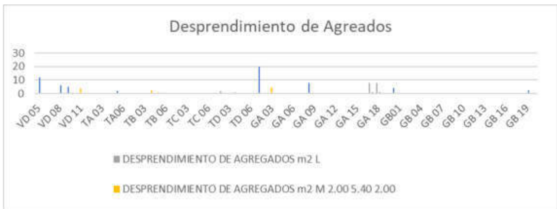
Figura 91. Distribución de deterioros (PR 0+000 – PR 2+383): desprendimiento de agregados Fuente: Elaboración propia
