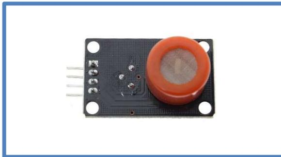
Fig. 27 Módulo del Sensor MQ3
