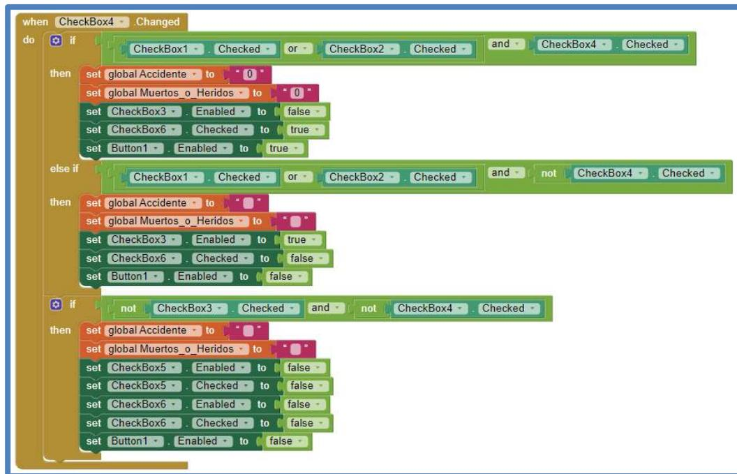
Fig. 106 Aplicación Android - Evento de Cambio de Estado del “CheckBox4” - X2: ¿El Conductor Participó en un Accidente de Tránsito? - No=0
