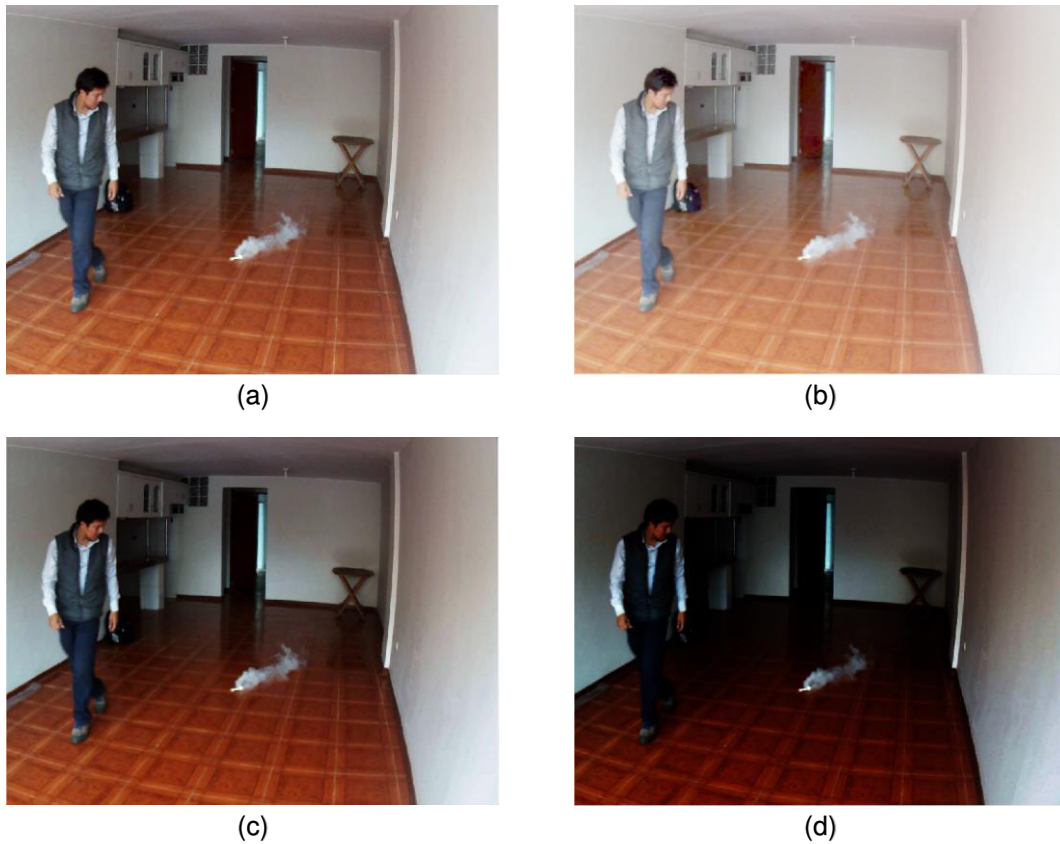
Figura 3.6 Corrección gamma en imágenes. (a) Imagen a analizar ( \gamma = 1 ). (b) Imagen a analizar ( \gamma = 0.5 ). (c) Imagen a analizar ( \gamma = 1.5 ). (d) Imagen a analizar ( \gamma = 3 ).
