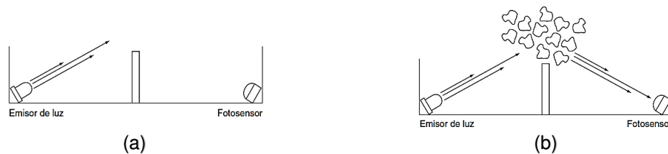
Figura 1.2 Principio de funcionamiento de los detectores de humo fotoeléctricos. (a) Detector por dispersión de luz. (b) Detector por dispersión de luz con humo.
