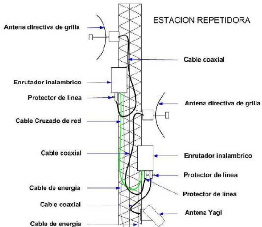
**Figura Nº 2.20: Estación Repetidora**
