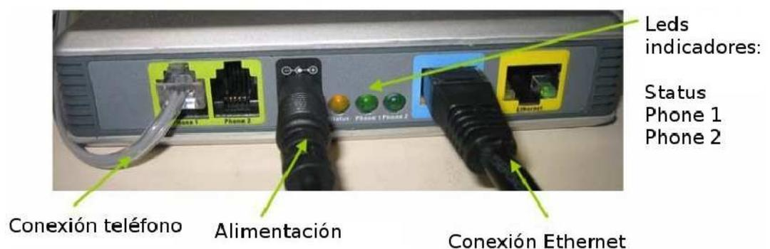
**Figura N° 2.23: Conexiones en un ATA**
