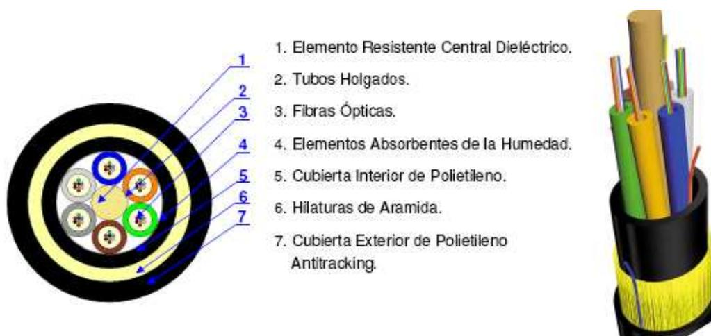
**Figura Nº 2.8: Cable de Fibra Óptica tipo ADSS**
