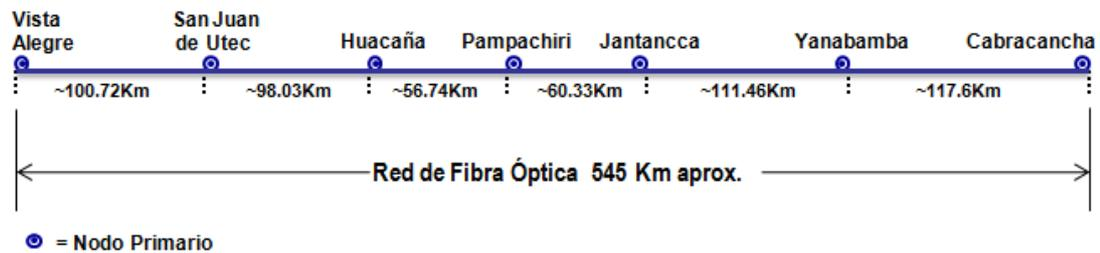
**Figura Nº 3.3: Topología Física del *Backbone* de Fibra Óptica del Proyecto**
