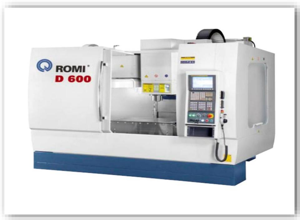
**Gráfico N° 12: Maquina centro de mecanizado CNC**
