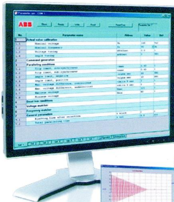
Fig. 12: Herramientas del SynView (de izquierda a derecha): Ajuste de parámetros Ventana de registro de valores transitorios Ventana de registro de eventos Ventana de valores medidos
