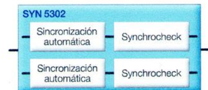
Fig. 8: Dos sistemas automáticos a doble canal para la más alta seguridad y la máxima disponibilidad
