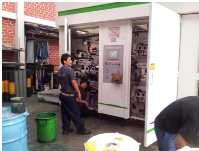
Figura N° 153: Operarios sin protección en el área de impresión. Fuente: Industrias Plásticas MarPlast S.A.C.
