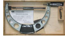
Micrómetro exteriores (175-200 mm).
