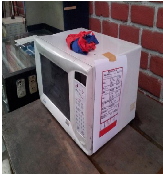
Figura N° 23: Tarjeta roja para microondas en el área de impresión. Fuente: Industrias Plásticas Marplast S.A.C.
