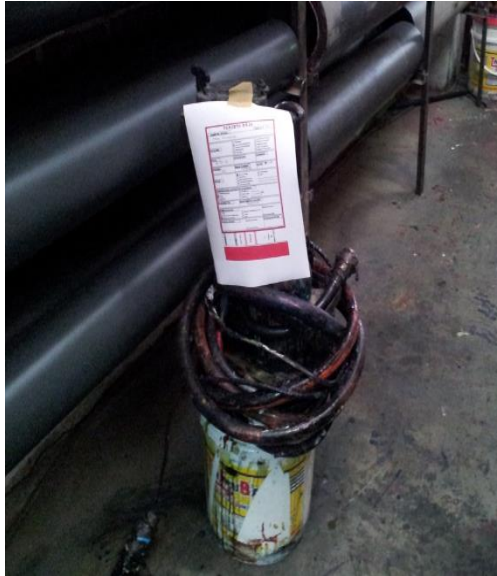
Figura N° 24: Tarjeta roja para bombas malogradas en el área de impresión. Fuente: Industrias Plásticas Marplast S.A.C.
