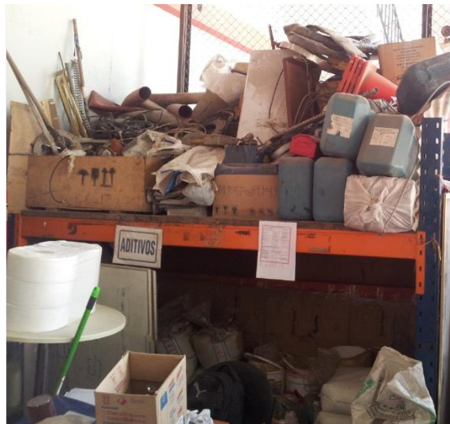
Figura N° 9: Tarjeta roja en elementos encima del estante de aditivos. Fuente: Industrias Plásticas Marplast S.A.C.
