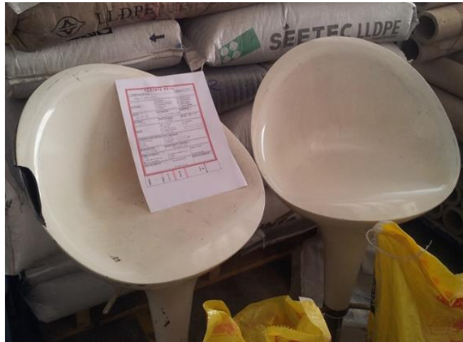
Figura N° 10: Tarjeta roja en sillas sin uso del área de almacén de M.P. Fuente: Industrias Plásticas Marplast S.A.C.
