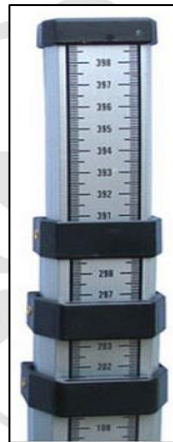
Figura N°19: Lectura en milímetros de la parte posterior de la regla. Fuente: Internet.
