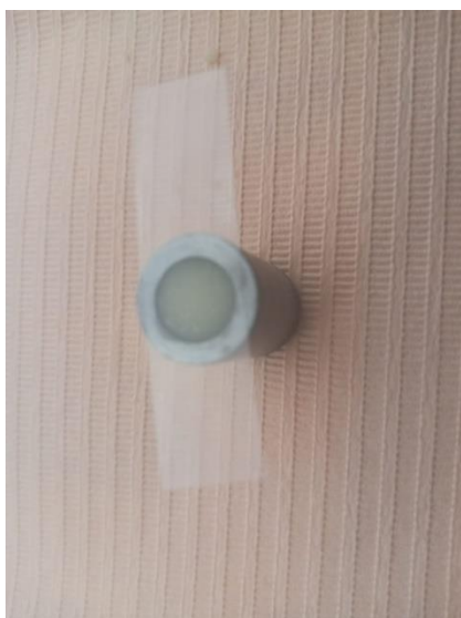
Imagen 7: Preparación de las muestras: Eliminación del material excedente con una cinta celuloide
