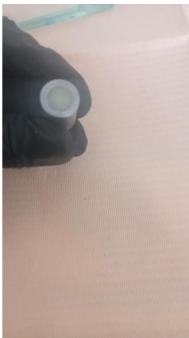
Imagen 9: Preparación de las muestras: Espécimen fotopolimerizado
