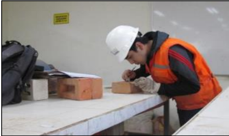
Figura 29: Técnica de medición de Alabeo en ladrillos
