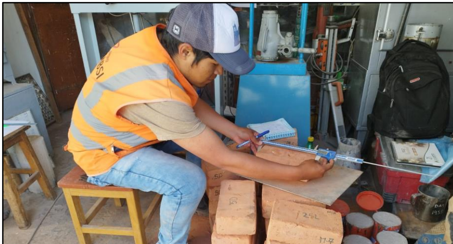
Figura 73: Medida de ancho de ladrillo
