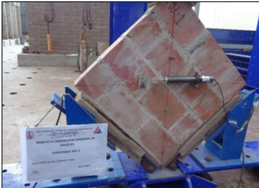
Figura 33: Ejemplo de Compresión Diagonal de Murete
