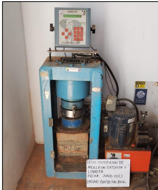
Figura 90: Compresión axila ladrillo de Liparita
