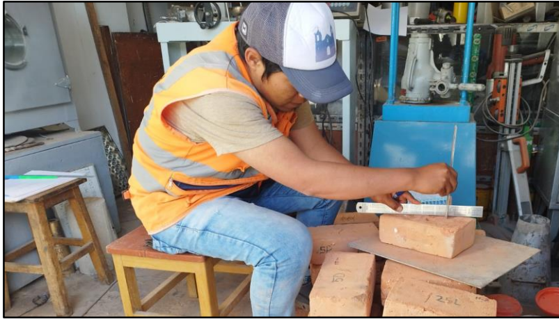
Figura 76: Superficie cóncava del espécimen
