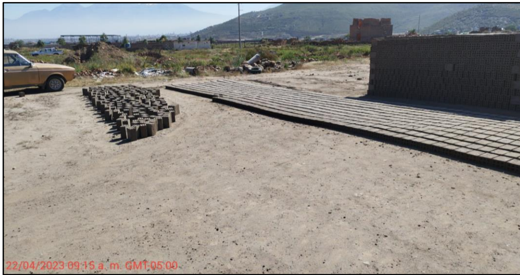
Figura 63: Secado de ladrillo con diatomita y liparita
