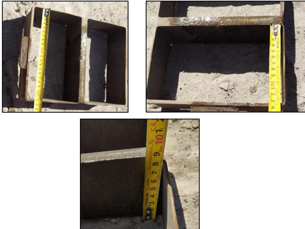
Figura 60: Medidas determinadas para elaborar ladrillo
