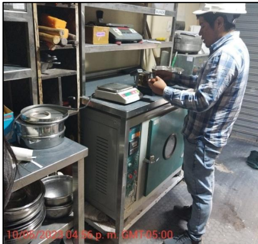
Figura 51: Ensayo de Atterbeg en diatomita y liparita
