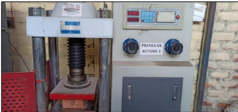
Figura 85: Ensayo de compresión espécimen con Liparita
