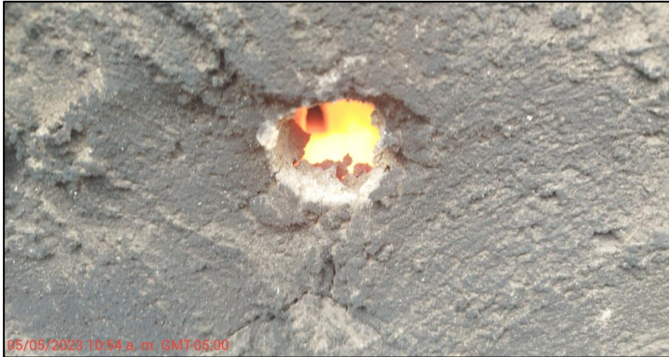
Figura 68: Verificación de cocción uniforme dentro de horno
