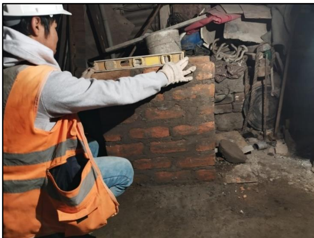
Figura 93: Fabricación de muretes (60x60 cm)
