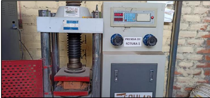
Figura 84: Ensayo de compresión espécimen con diatomita
