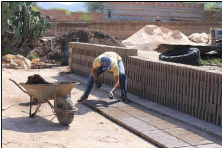
Figura 31: Proceso de moldeo ladrillo artesanal
