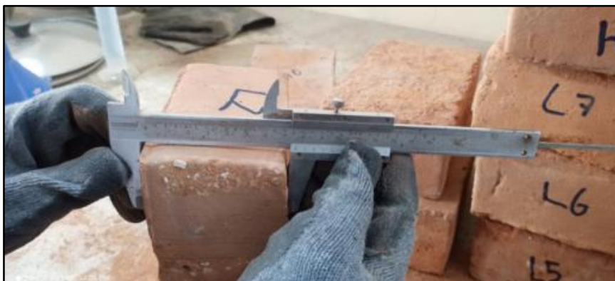
Figura 74: Medida de ladrillo (alto)
