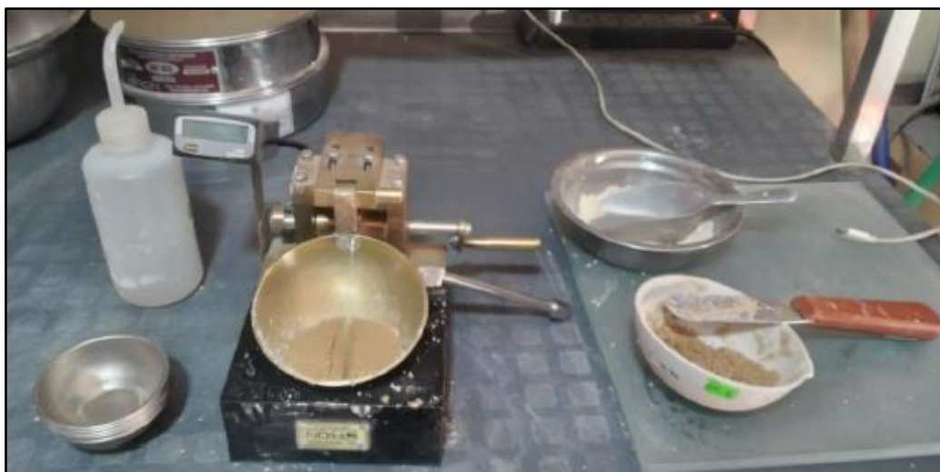
Figura 50: Materiales para determinar límite líquido e índice plástico
