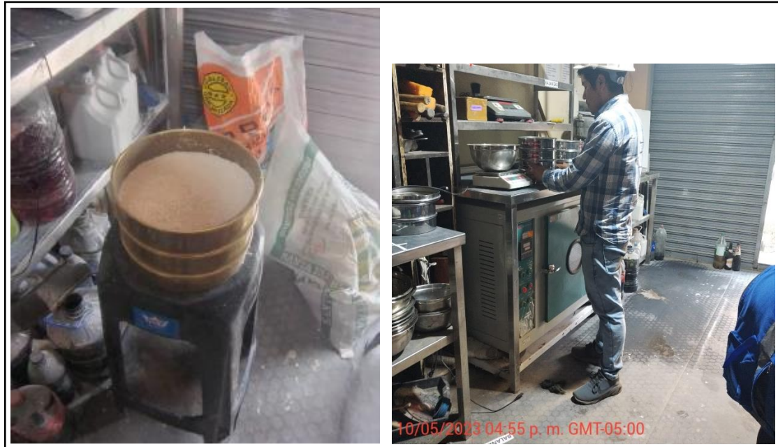
Figura 47: Tamizado de materiales liparita - diatomita
