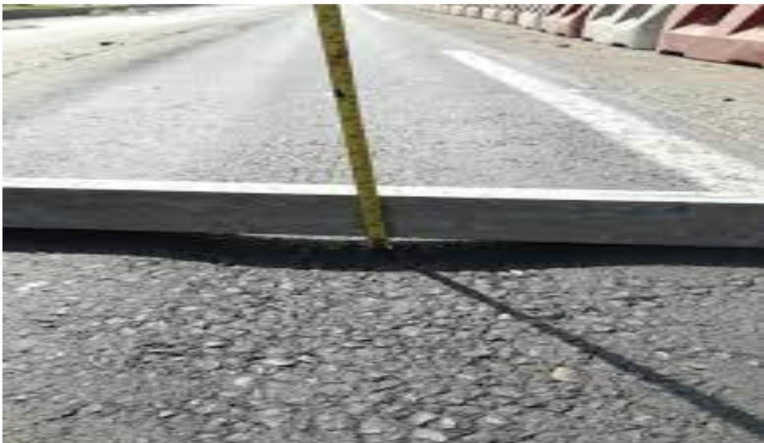
**Figura 32.** Abultamiento y hundimientos
