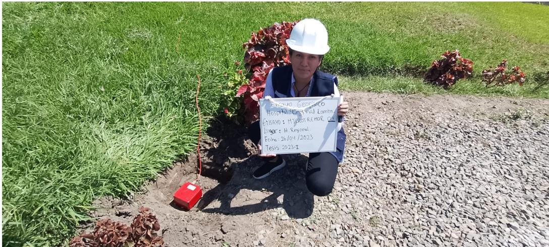
Nota. La figura muestra la ubicación y toma del Microtremor-04 en suelo con el sismógrafo GeoBox. Elaboración: Los autores. (2023)
