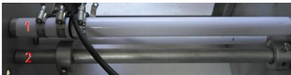
Figura 34 Rodillo soporte de sensores (1), Rodillo soporte de cuchillas (2)
