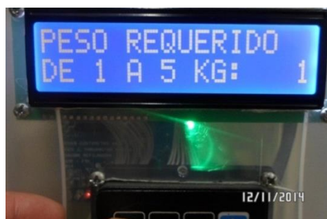
Figura 152 Ingreso del peso requerido (en Kg) de material a cortar Elaboración: el autor
