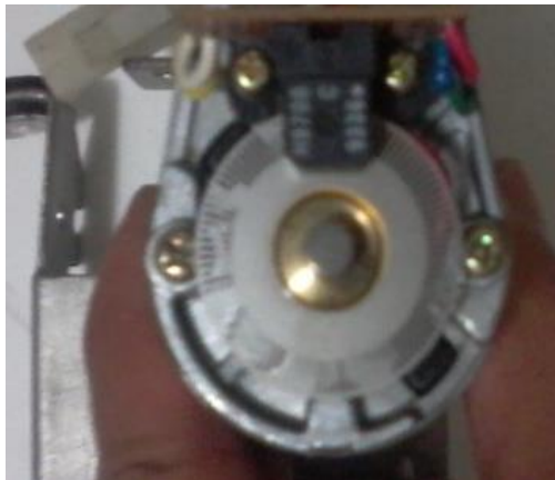
Figura 23 Contómetro de 100 pasos por vuelta
