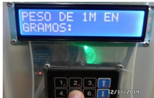
Figura 151 Ingreso del peso (en gramos) de un metro de material a cortar Elaboración: el autor
