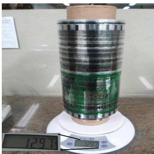
Figura 158 Peso de bobina 2 con producto retilado Elaboración: el autor
