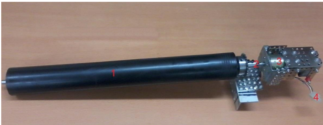
Figura 102 Rodillo vulcanizado conectado a un motor que contiene un contómetro
