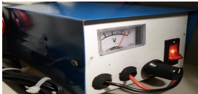
Figura 25 Fuente de voltaje 220V AC / 24V DC – 2A Elaboración: el autor
