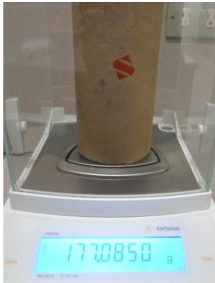
Figura 145 Medición del peso de la bobina 1 vacía Elaboración: el autor
