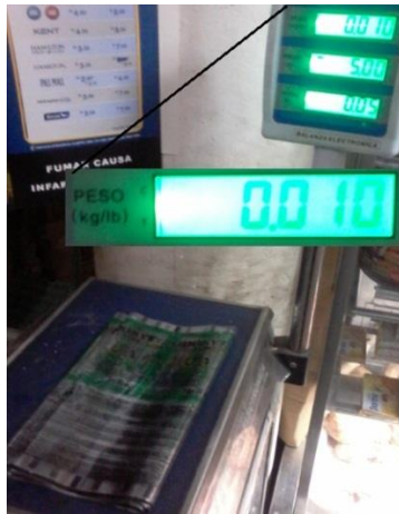
Figura 149 Medición del peso de dos metros de material a refilar Elaboración: el autor
