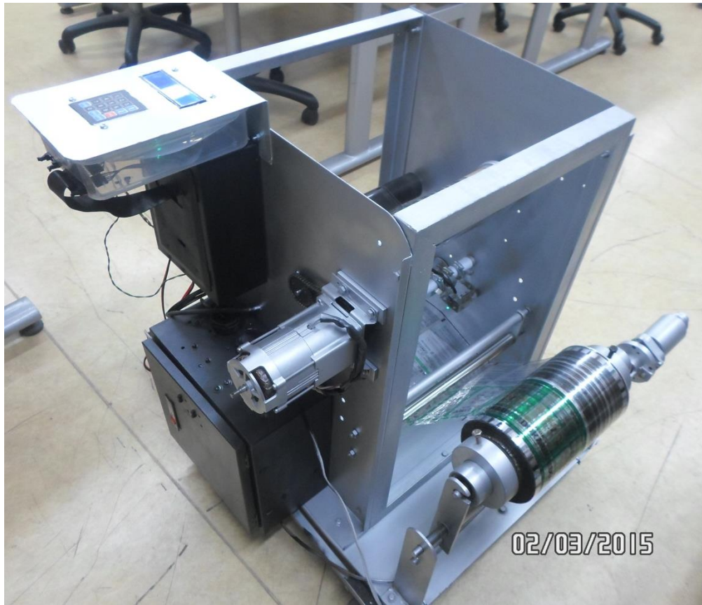
Figura 53. Estructura de máquina refilladora Elaboración: el autor
