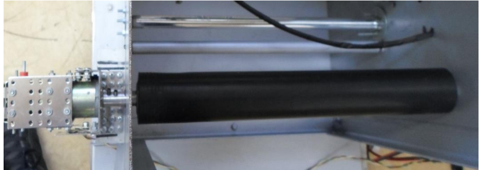
Figura 39 Rodillo vulcanizado color negro Elaboración: el autor
