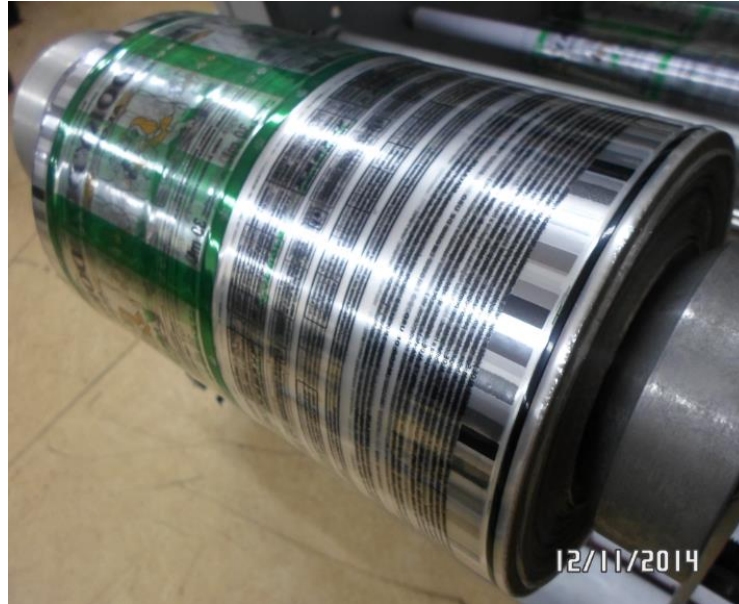
Figura 147 Producto a refilar con taca al lado derecho
