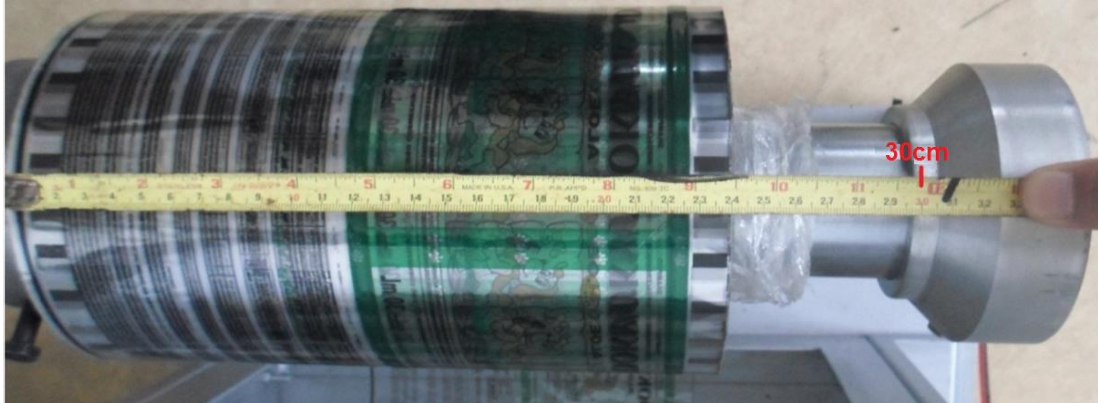
Figura 159 Longitud máxima del rodillo a refilar Elaboración: el autor
