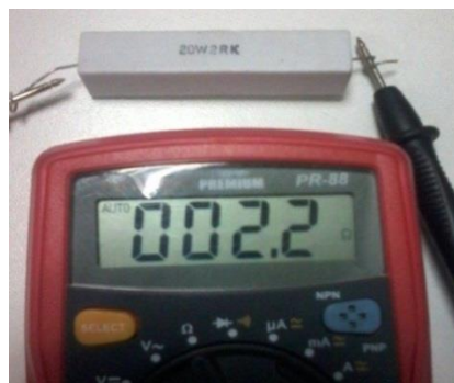
Figura 141 Medición del valor real de la resistencia Elaboración: el autor
