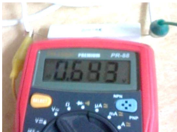
Figura 144 Medición del voltaje en la resistencia de dos ohmios de la máquina refilladora en operación
