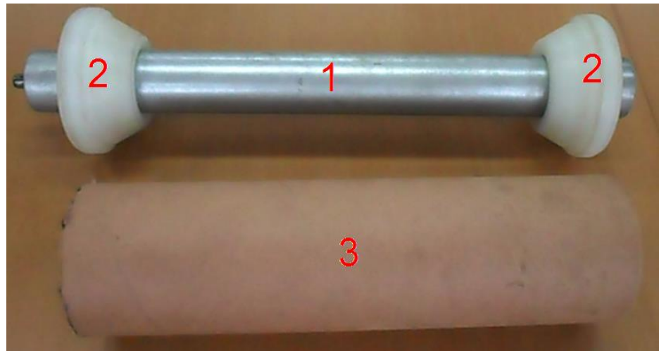
Figura 37 Rodillo desmontable final (1), conos de ajuste (2), bobina vacía (3)
