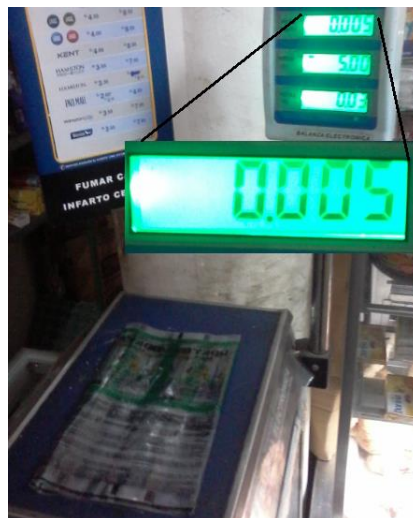
Figura 148 Medición del peso de un metro de material a refilar
