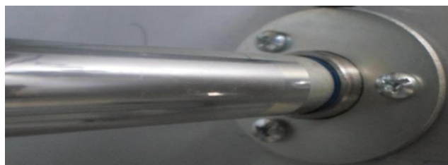
Figura 76 Diseño de acople instalado en la estructura de máquina refiladora
