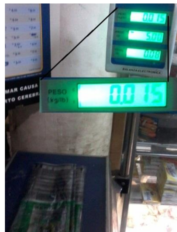
Figura 150 Medición del peso de tres metros de material a refilar Elaboración: el autor
