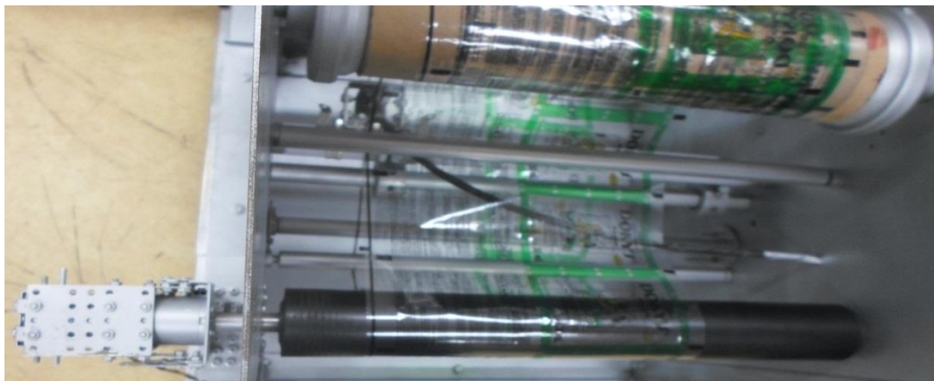
Figura 108 Contómetro de medición de vueltas en la estructura de la máquina retiladora Elaboración: el autor
