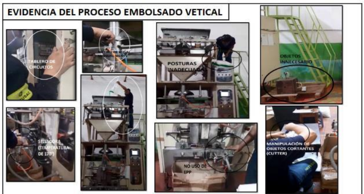
Figura X4. Evidencia de peligros y riesgos del proceso de Embolsado Vertical. Elaborado por: los autores.
