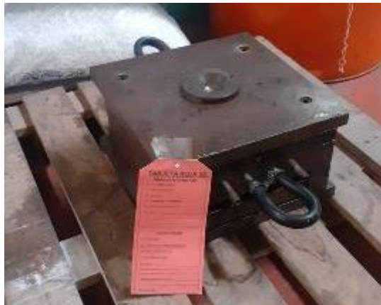
Figura 354. Molde de crucetas que ya cumplió su vida útil (inservible). Elaborado por: los autores
