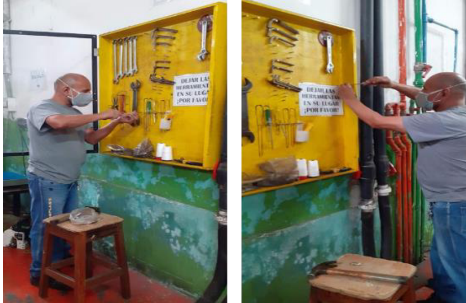
Figura 375. Colocación de pernos para la sujeción de herramientas y colocación de avisos. Elaborado por: los autores
