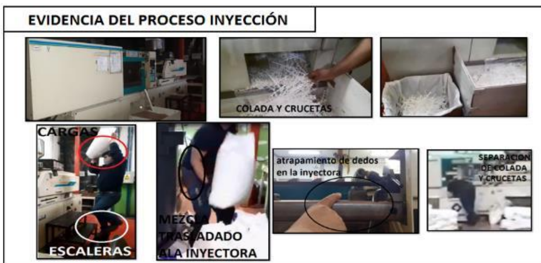
Figura X2. Evidencia de peligros y riesgos del proceso de Inyección. Elaborado por: los autores.
