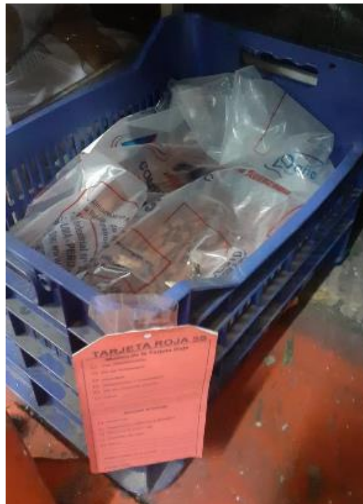
Figura 352. Tarjeta roja en producto defectuoso y canasta inservible. Elaborados por los autores
