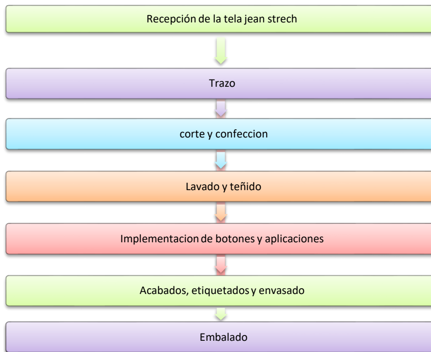
Figura 24. Proceso productivo de los pantalones jeans cintura
