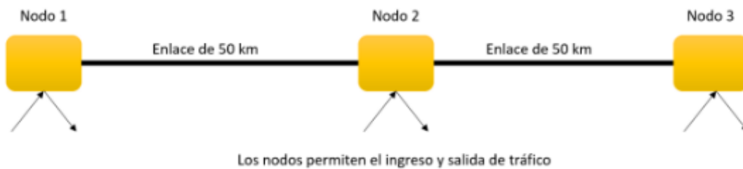
Figura 10 Infraestructura de nodos junto a la fibra óptica
