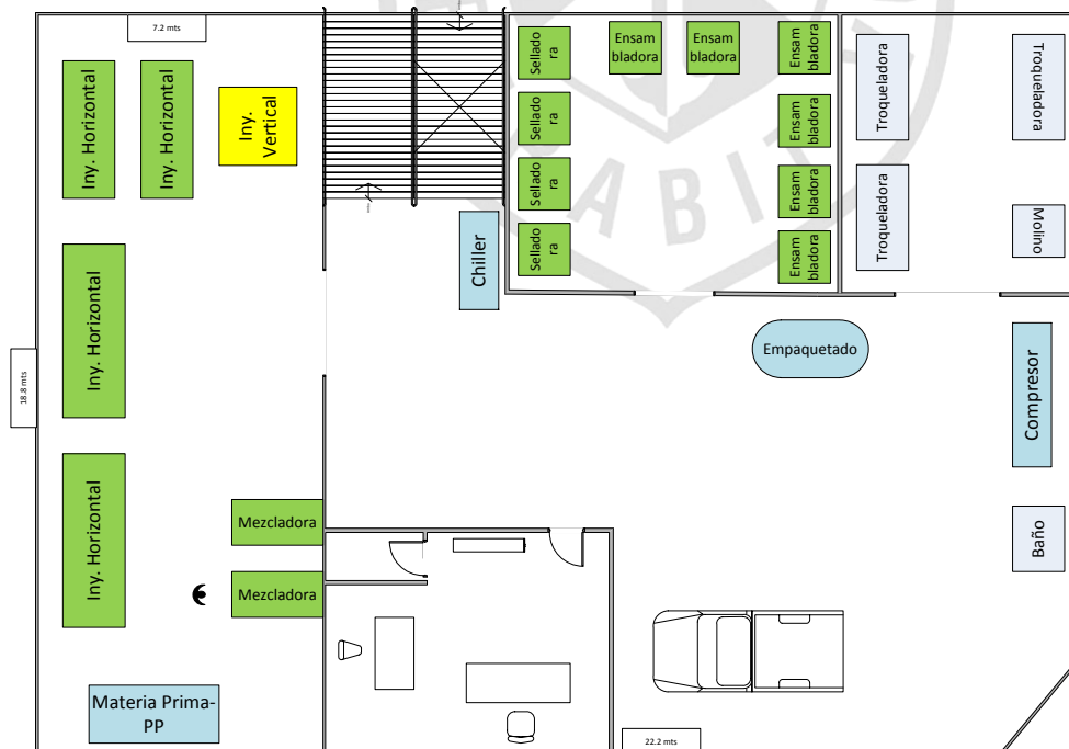
Figura N°3.11 Plano: Vista de Planta del 1er piso de la empresa LEÓN PLAST con la nueva redistribución.
