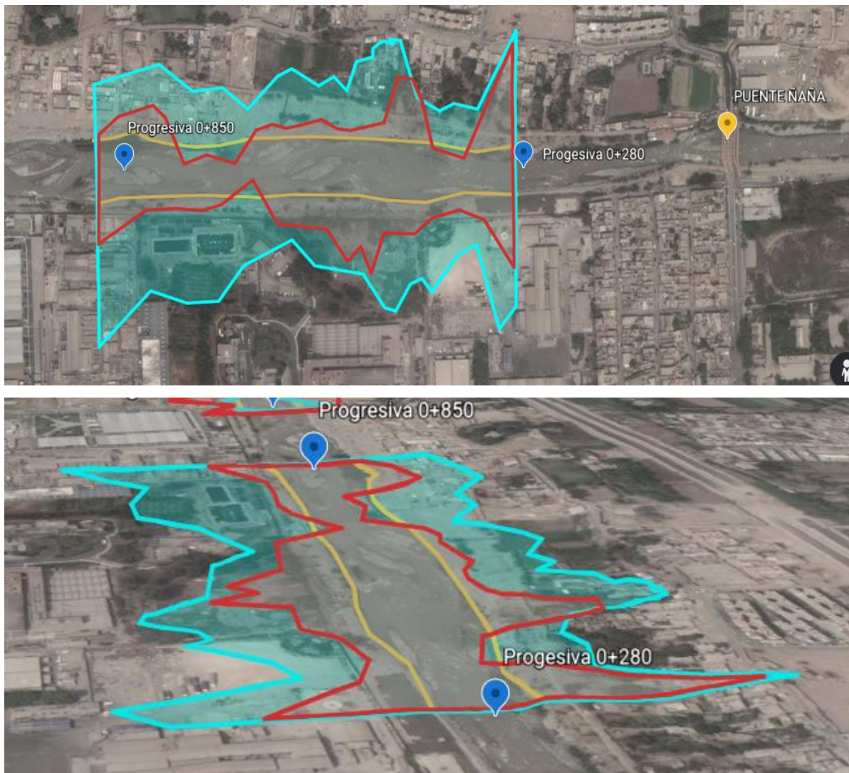
Figura 105 Área de inundación de tramo 4 – Dique 4
