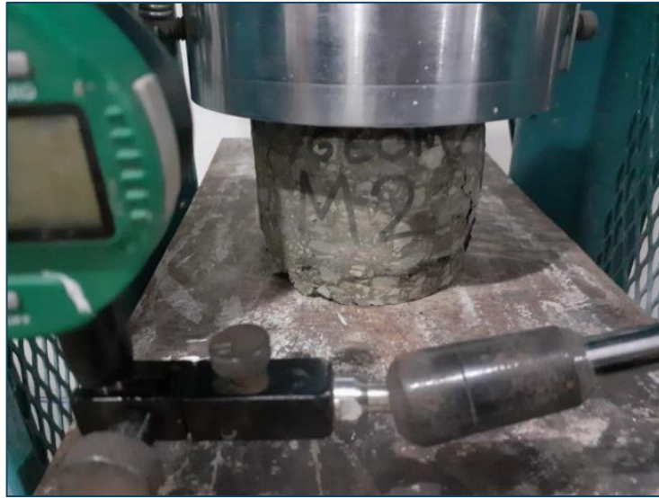
Figura 62. Resistencia a la compresión – Muestra 2 con refuerzo
