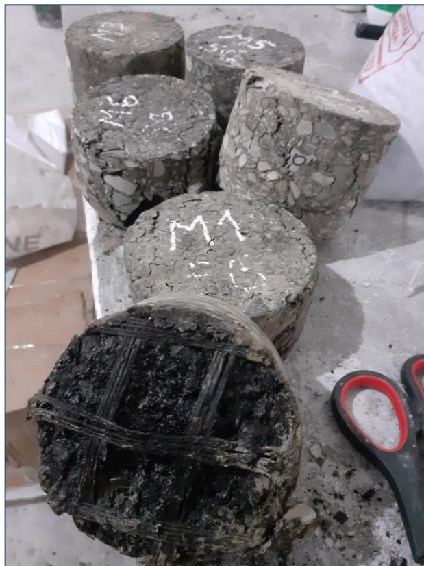
Figura 64. Muestra de pavimento con refuerzo Elaborado por: los autores
