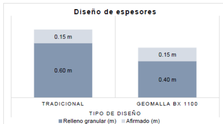
Figura 6. Diseño tradicional vs Diseño con geomalla biaxial
