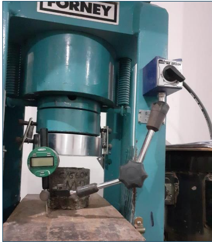
Figura 63. Resistencia a la compresión – Muestra 3 con refuerzo Elaborado por: los autores
