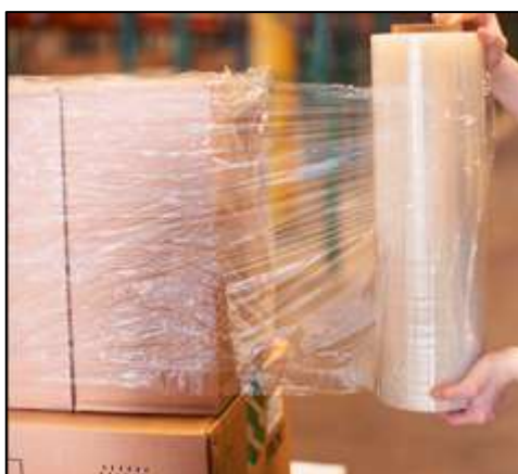
Figura 25. Proceso de sellado con Strech Film
