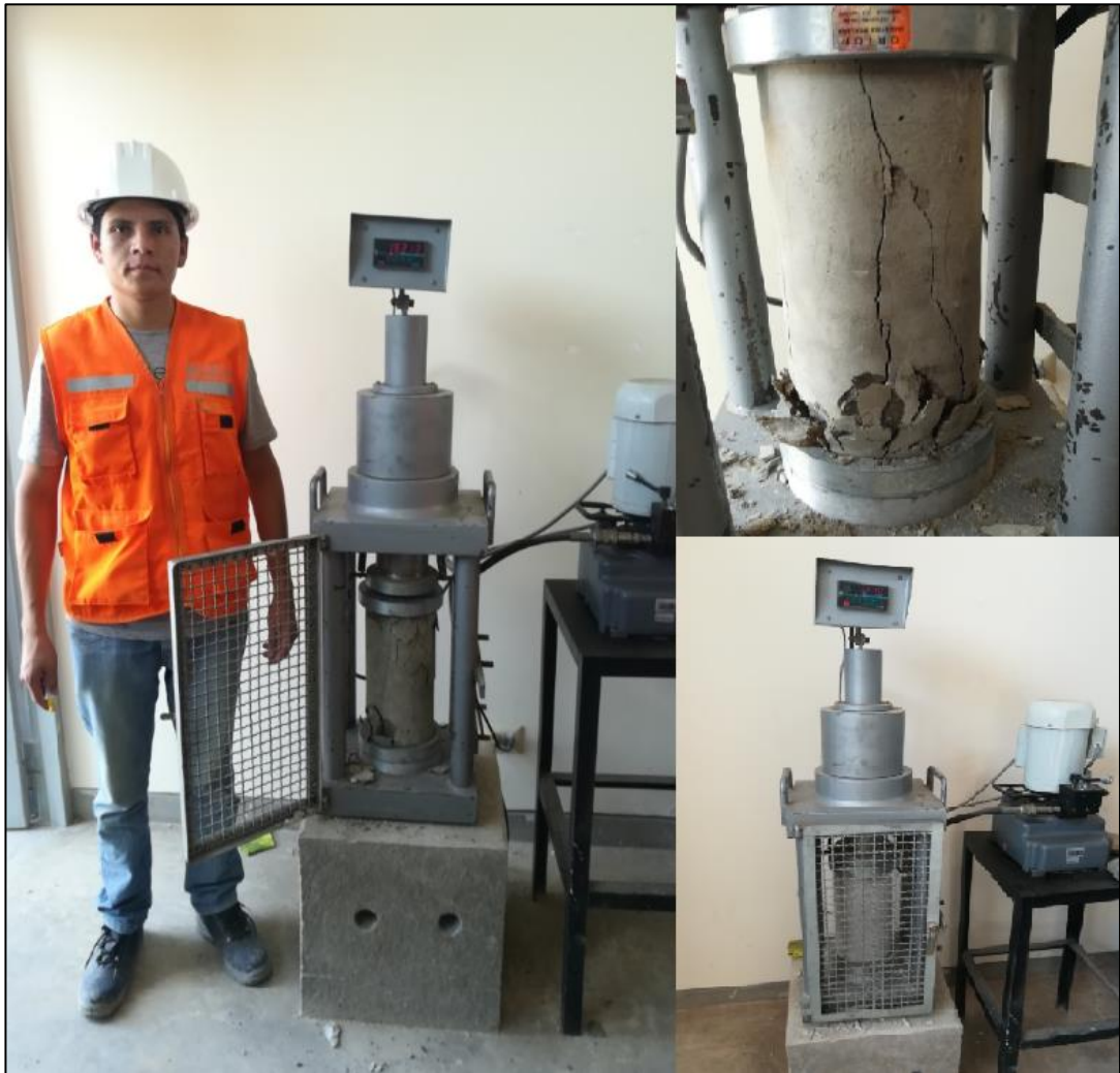
Figura 50. Rotura de probetas cilíndricas
