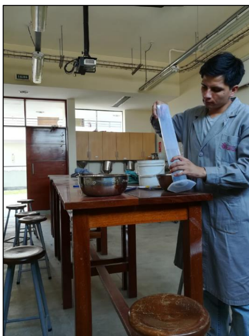
Figura 36. Ensayo de peso específico del agregado grueso
