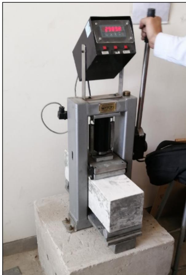
Figura 28. Rotura de viga para ensayo de resistencia a la flexión
