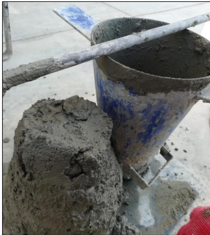
Figura 21. Ensayo de consistencia
