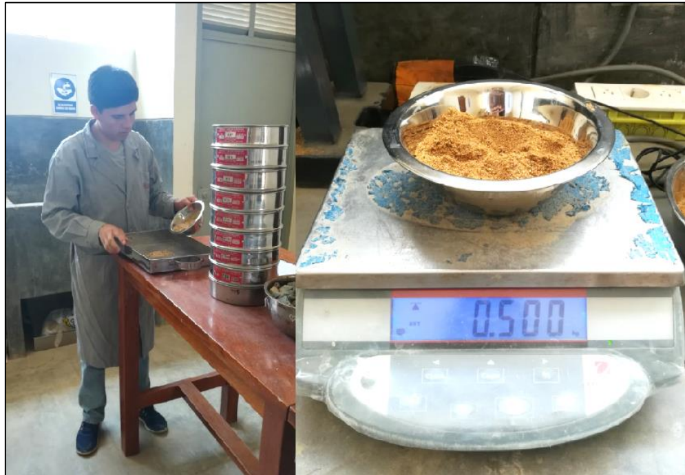
Figura 31. Granulometría de la arena gruesa
