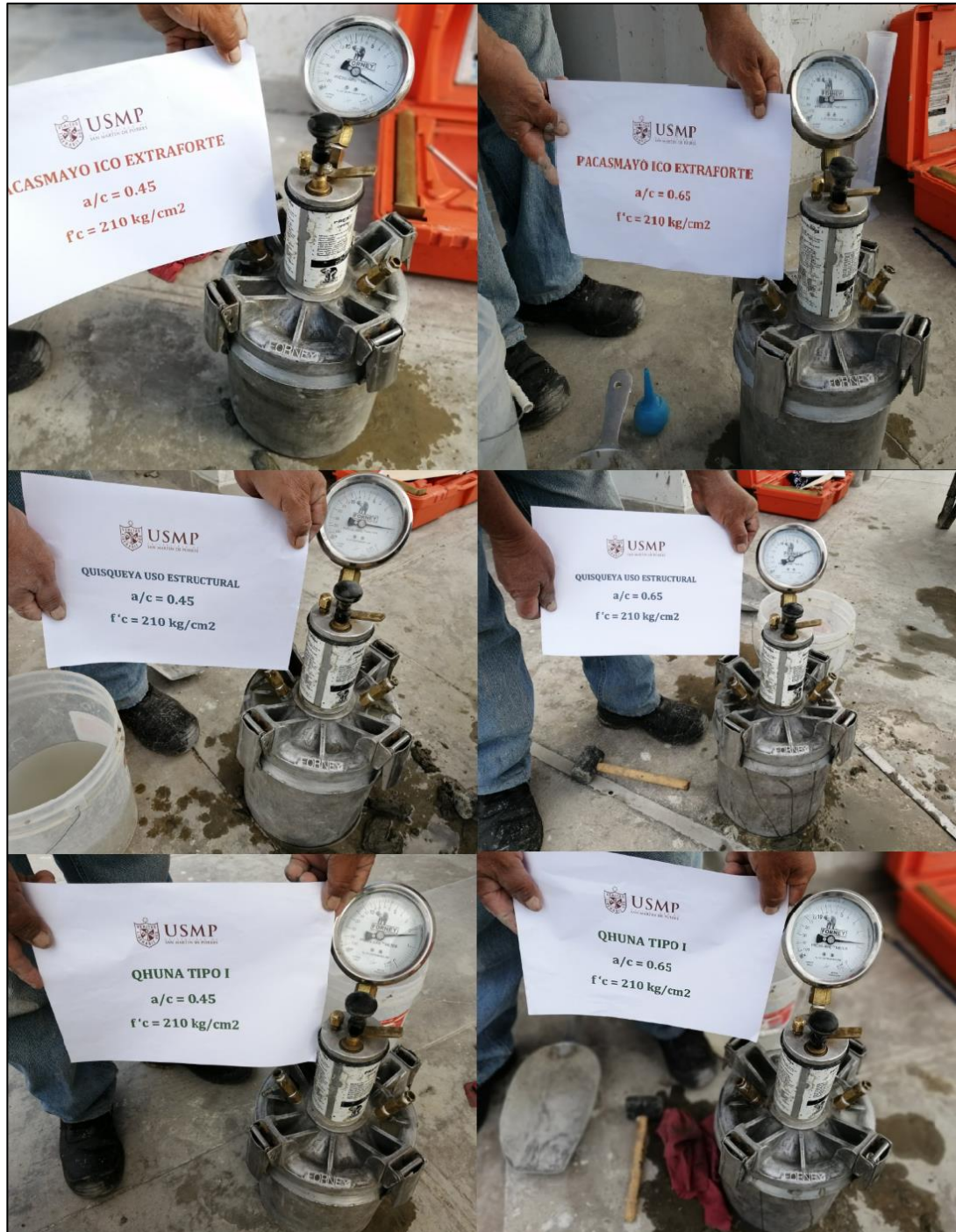
Figura 47. Ensayo de contenido de aire del concreto fresco
