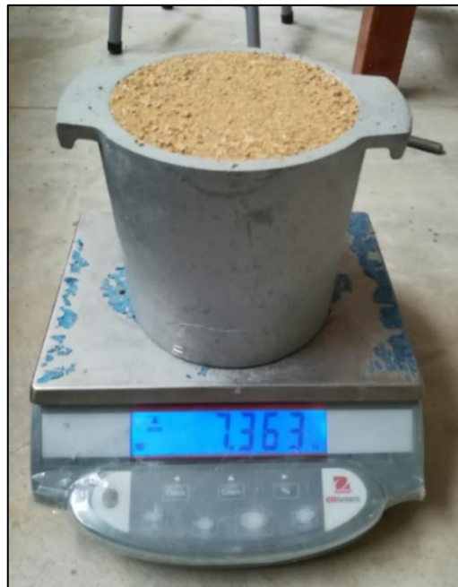
Figura 41. Ensayo de peso unitario compactado del agregado fino
