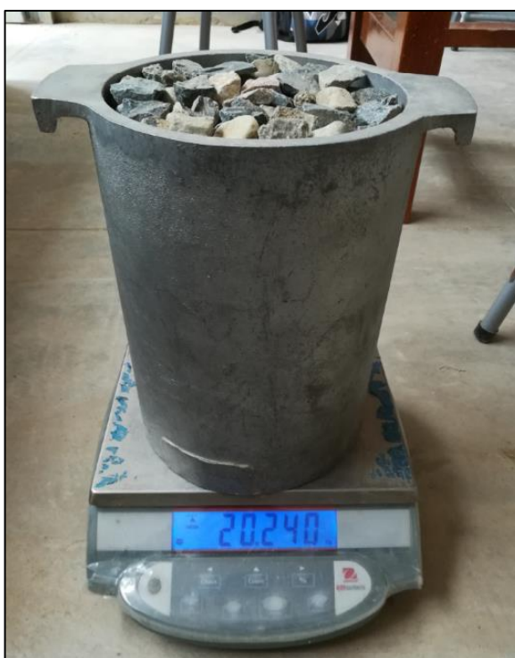
Figura 40. Ensayo de peso unitario del agregado grueso
