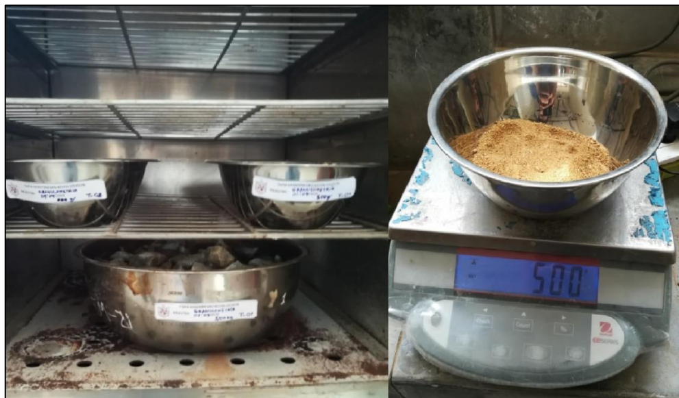
Figura 37. Ensayo de contenido de humedad del agregado fino
