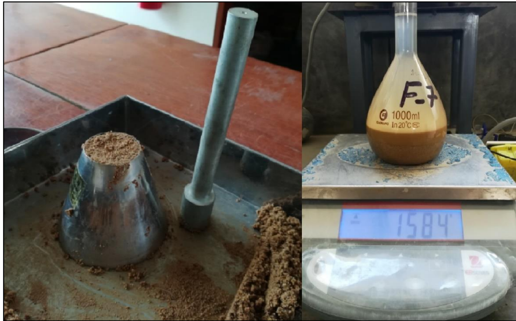
Figura 35. Ensayo de peso específico del agregado fino
