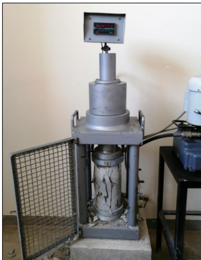
Figura 25. Rotura de probeta para ensayo de la resistencia a la compresión
