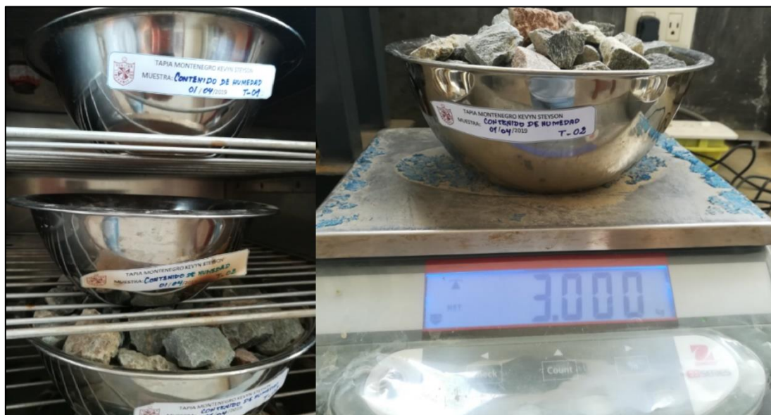
Figura 38. Ensayo de contenido de humedad del agregado grueso
