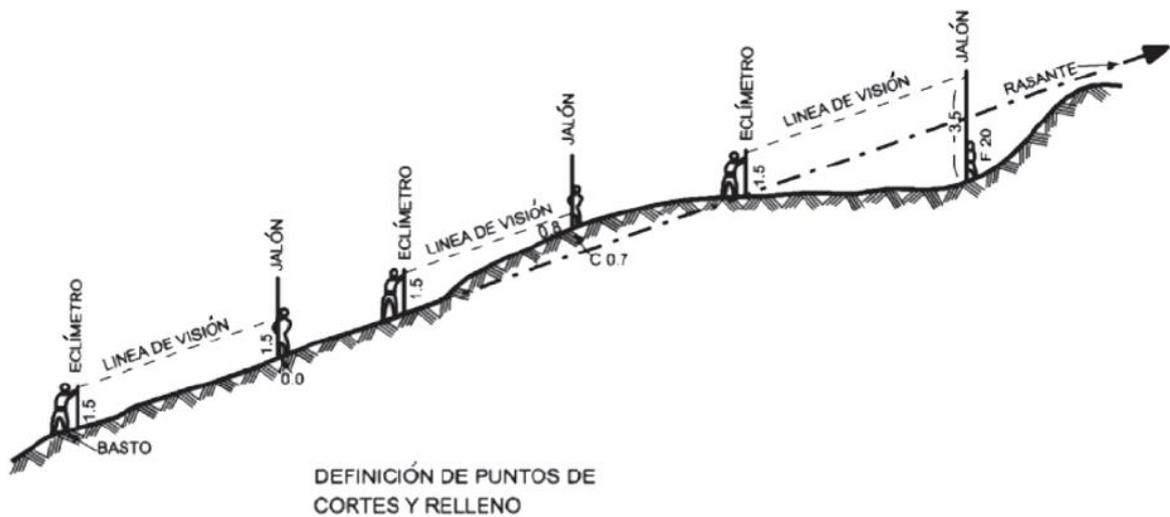
**Figura 27.** Equipo topográfico de campo para Corte y Relleno
