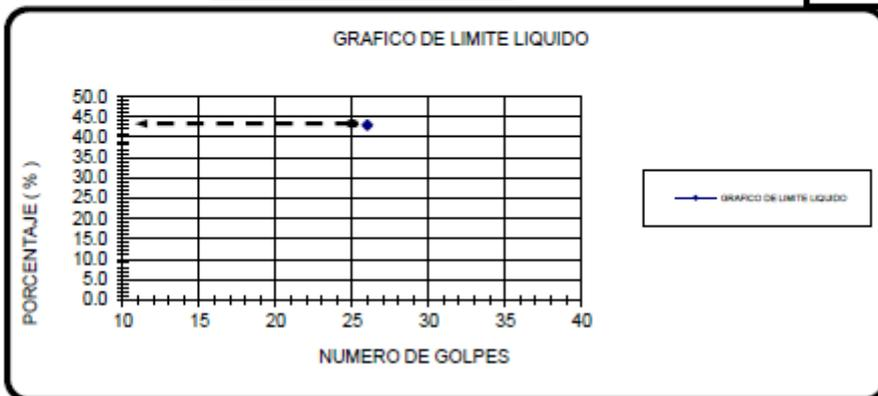
**Anexo 51: Ensayo de Limites de Consistencia de la C7 de la Vía Rio Espino-
