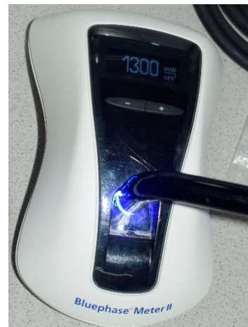
Fig. 12. Calibración de la Lámpara Bluephase. Con Radiómetro. 1300 MW
