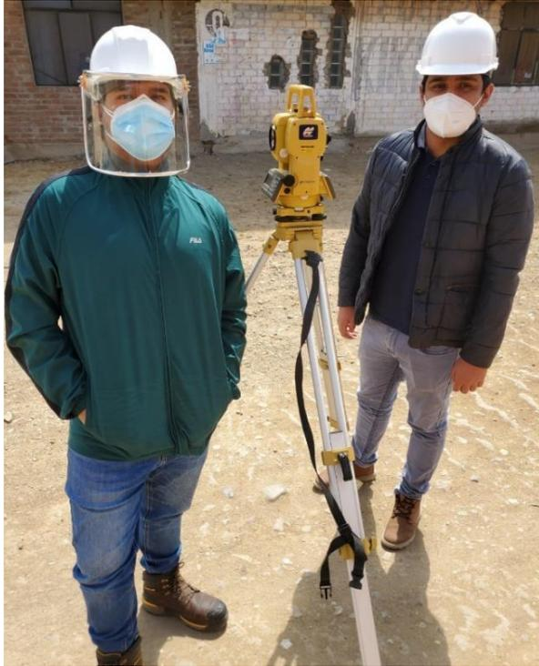
**Figura 29.** Estación total empleada para el levantamiento topográfico.
