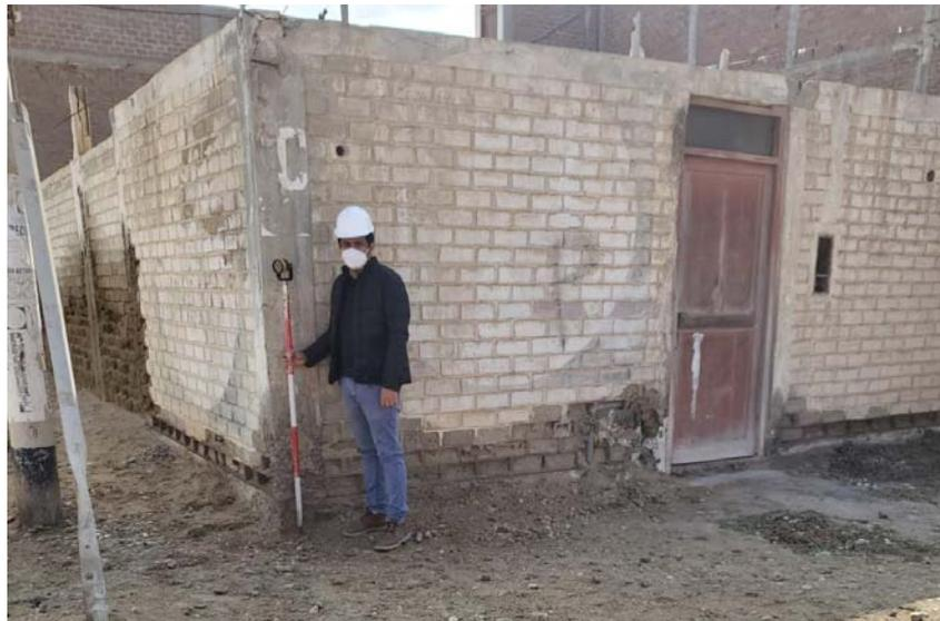
**Figura 30.** Prismas empleados para el levantamiento topográfico.
