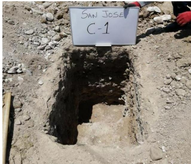
**Figura 32.** Calicata N° 1 (C-1) red de alcantarillado.
