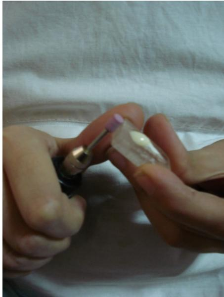
**FIGURA 6:** DESGASTE DE LAS PROBETAS DE ACRILICO
