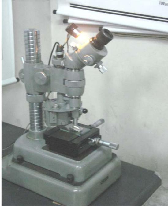
**FIGURA 3: MICRODUROMETRO DE VICKERS**
