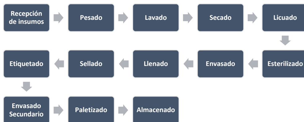
Ilustración 34. Proceso productivo conserva de jalapeño rojo en pasta
