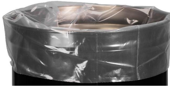
Figura 25. Carcasa envuelta con LDPE sin sellar al vacío.
