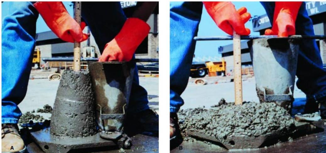
**Figura 06:** Ensayo de asentamiento
