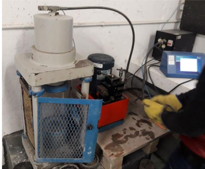
**Figura 17:** Máquina de Compresión axial electro-hidráulica, capacidad: 250,000 lbf, Marca: Humboldt
