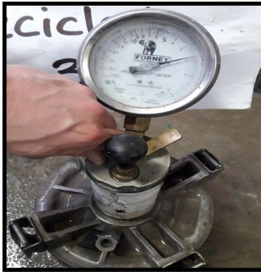
**Figura 08:** Medidor del tipo de presión para la determinación del contenido de aire
