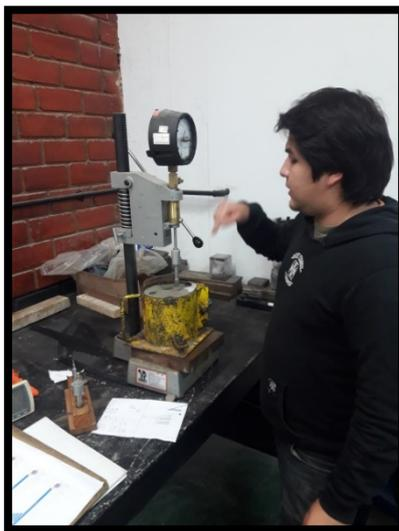
Figura 33: Ensayo de tiempo de fragua
