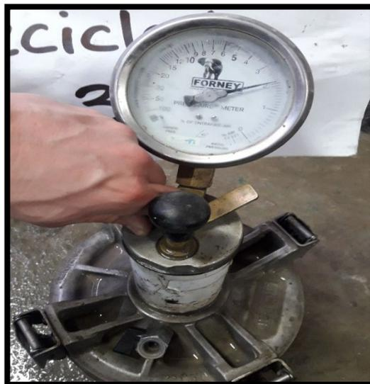
**Figura 20:** Medidor contenido de aire de concreto fresco "PRESS – AIRE – METER, capacidad: 0% a 100%, Marca: Forney
