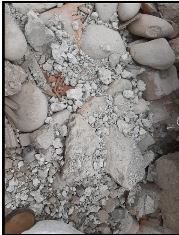
**Figura 26:** Concreto reciclado triturado
