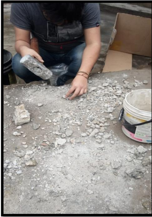
**Figura 25:** Trituración del concreto
