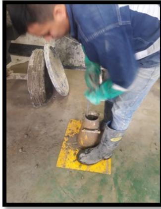
**Figura 31:** Ensayo de consistencia
