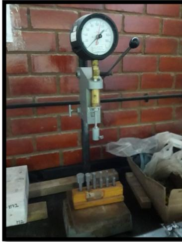
**Figura 21:** Penetrómetro para determinar tiempos de fraguados, capacidad: 200lbf, Marca: Forney
