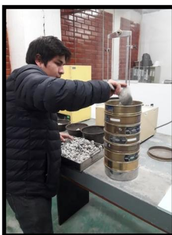
**Figura 28:** Ensayos de Granulometría
