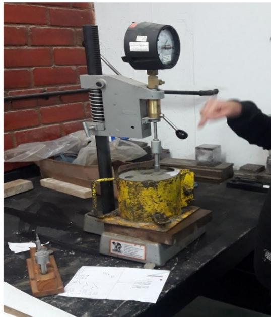
**Figura 09:** Medidor de tiempo de fragua por penetración
