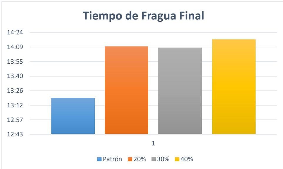
**Figura 56:** Comparación de Tiempos de Fragua Final de los 4 diseños
