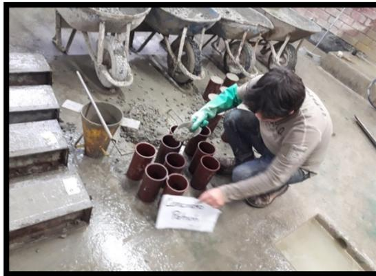
**Figura 34:** Preparación de probetas
