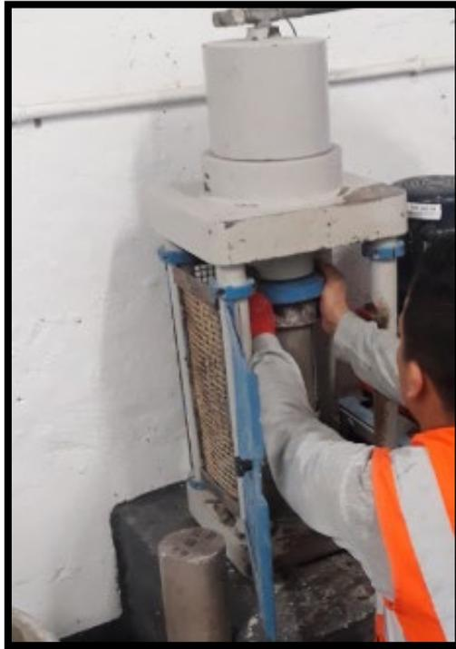
**Figura 14:** Ensayo a Compresión de probetas cilíndricas
