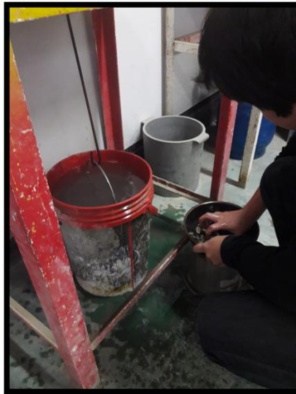
**Figura 29:** Ensayo de Peso específico y Absorción
