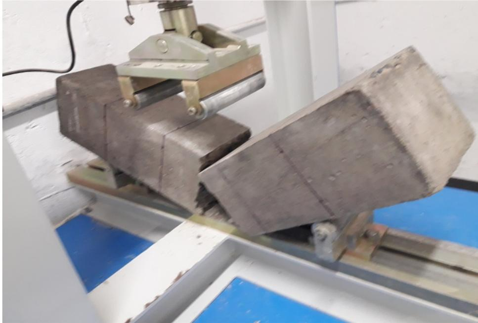
**Figura 16:** Ensayos a Flexión
