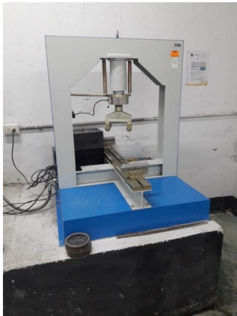
**Figura 18:** Máquina de Flexión, capacidad: 200 KN, Marca: UTC- 5600
