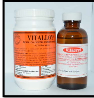
Foto 6. Metil metacrilato utilizado para la fijación de los pilares dentro del cilindro.
