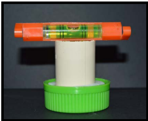
Foto 3. Paralelizado de cilindros dentro de bloque de silicona para estabilización.
