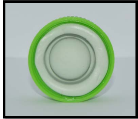
Foto 2. Bloque de silicona base para duplicado del patrón maestro.
