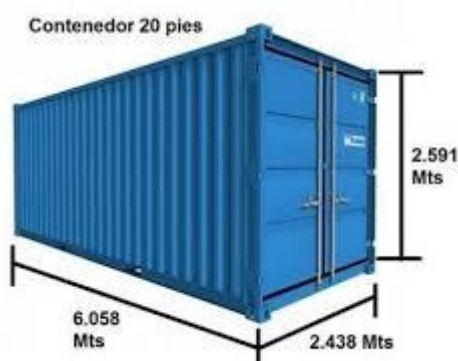
Figura 34 Medidas de container de 20 pies
