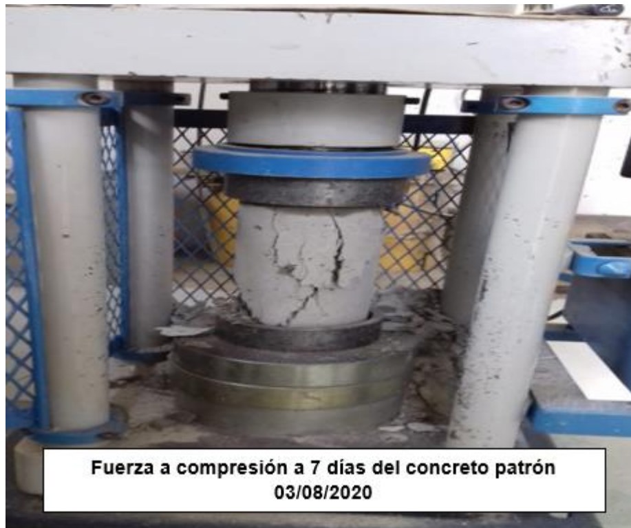
Figura 54. Roturas del concreto patrón a 7 días Fuente: Elaborado por los autores
