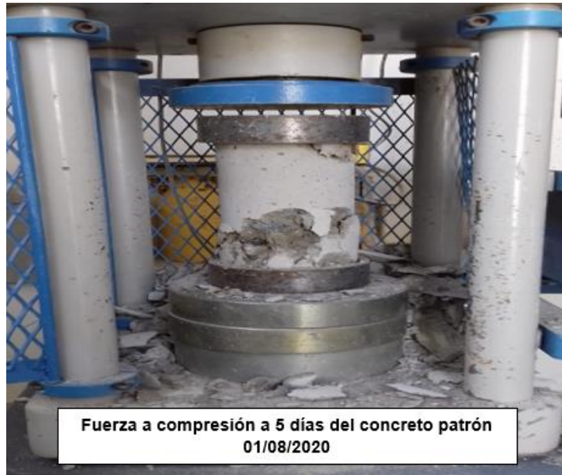
Figura 52. Roturas del concreto patrón a 5 días. Fuente: Elaborado por los autores
