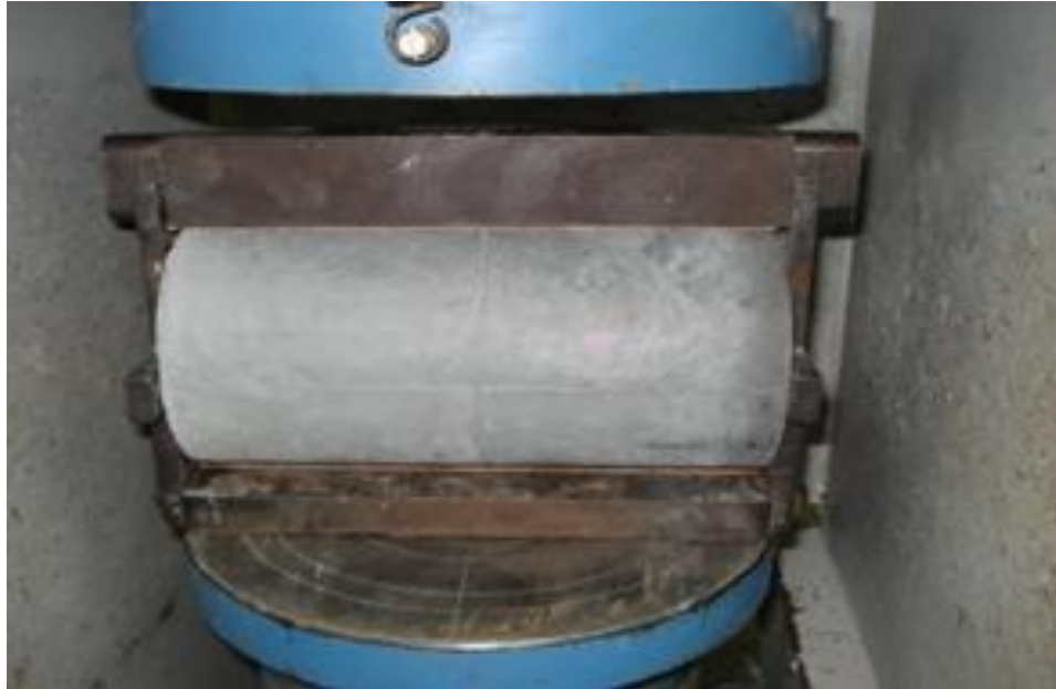
Figura 56. Roturas a tracción del concreto patrón a 3 días. Fuente: Elaborado por los autores
