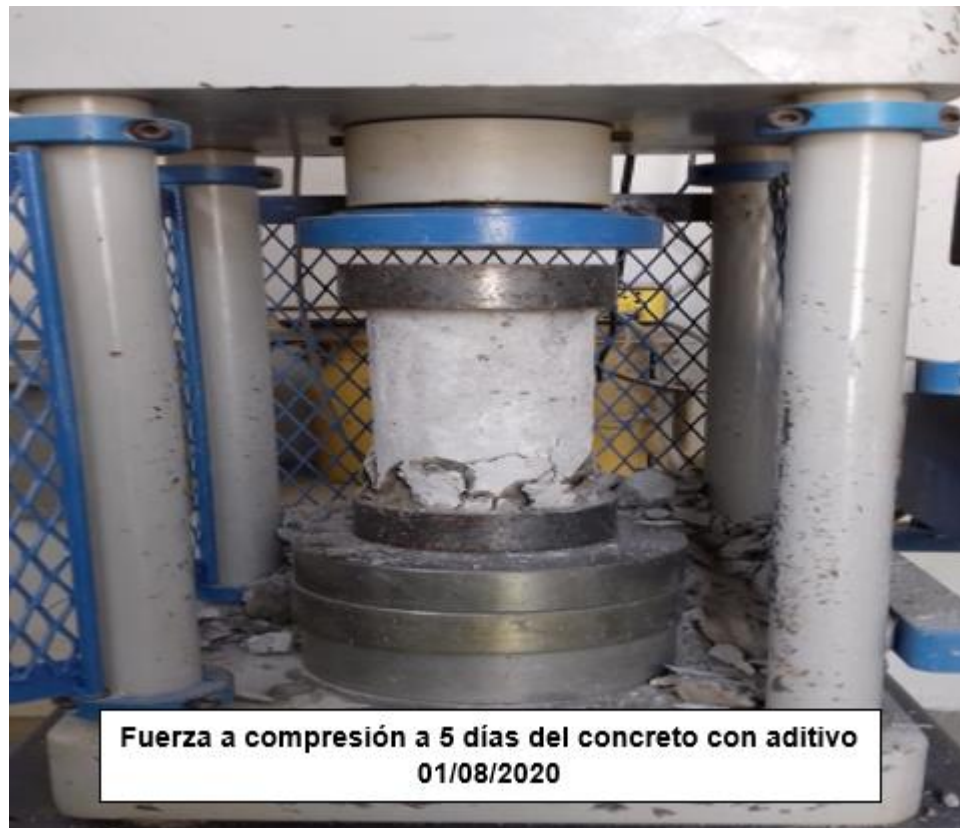
Figura 53. Roturas del concreto + 1.0 % aditivo Chema Estruct a 5 días Fuente: Elaborado por los autores
