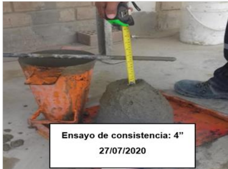
Figura 45. Asentamiento del concreto patrón Fuente: Elaborado por los autores
