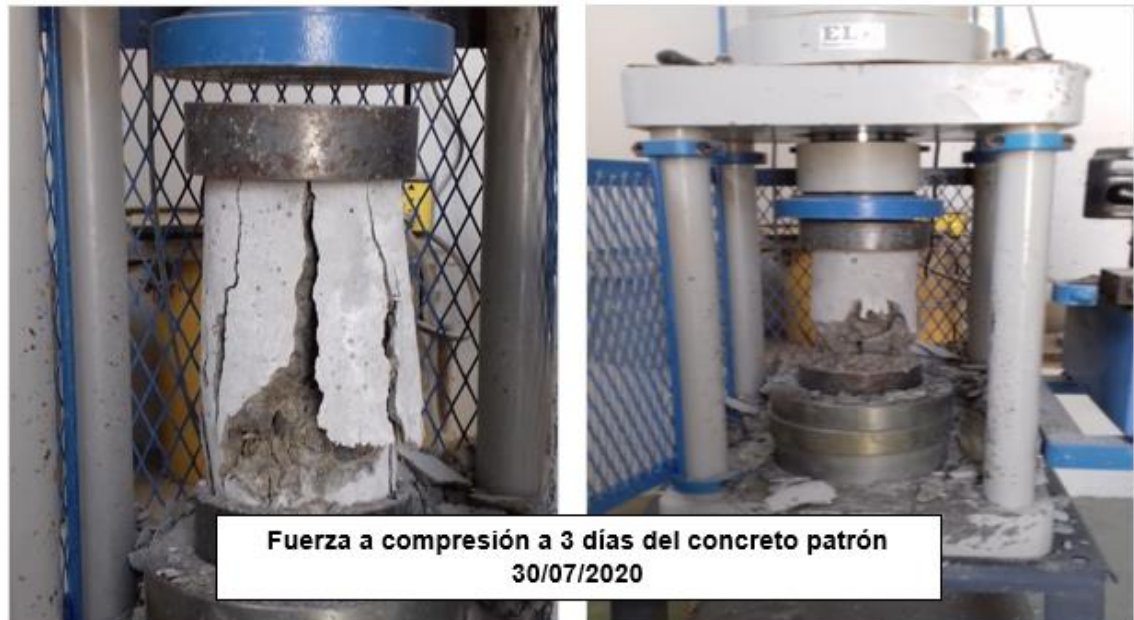
Figura 50. Roturas del concreto patrón a 3 días. Fuente: Elaborado por los autores
