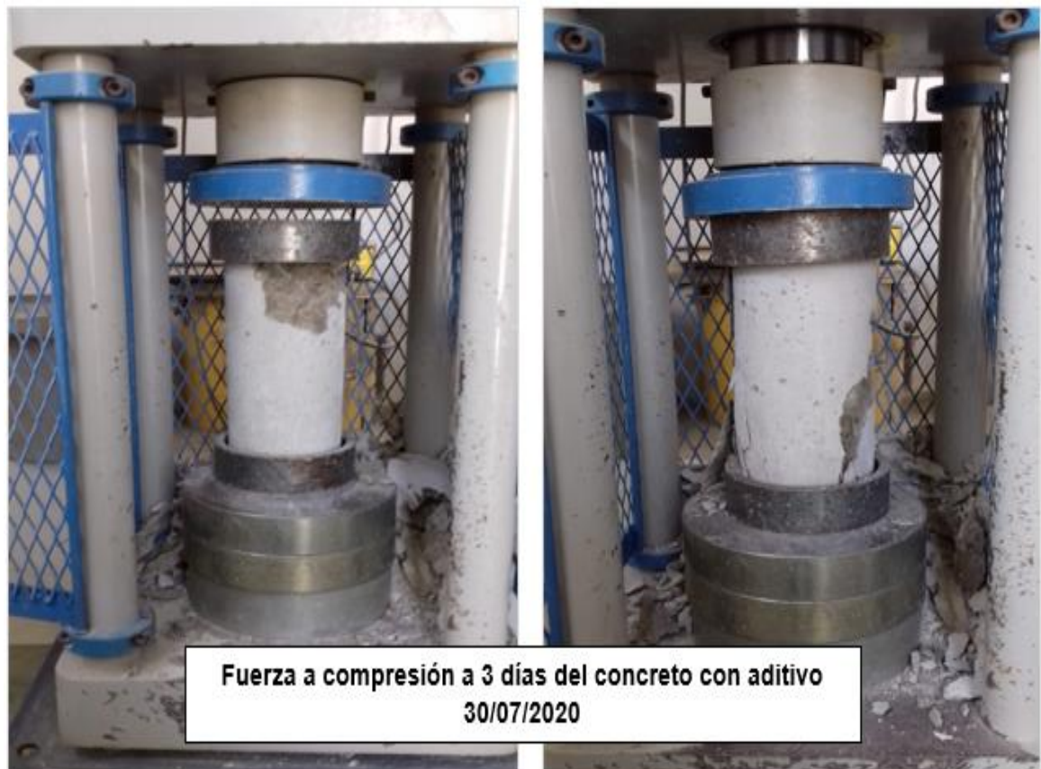
Figura 51. Roturas del concreto + 1.0 % aditivo Chema Estruct a 3 días.
