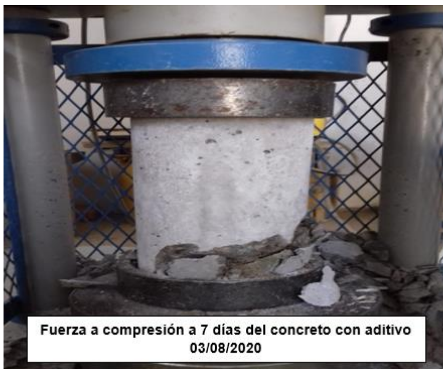
Figura 55. Roturas del concreto + 1.0 % aditivo Chema Estruct a 7 días Fuente: Elaborado por los autores
