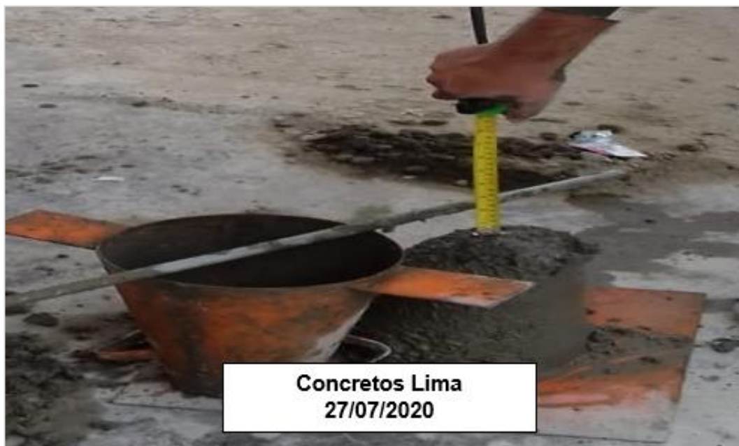
Figura 6. Extracción del cono de Abrams y medición del asentamiento Fuente: Elaborado por los autores
