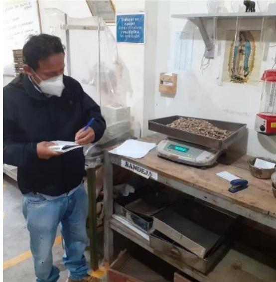
**Figura 26.** Peso de muestras para análisis granulométrico, agregado grueso
