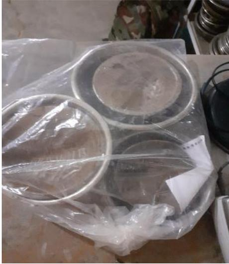
**Figura:** Saturación de muestra
