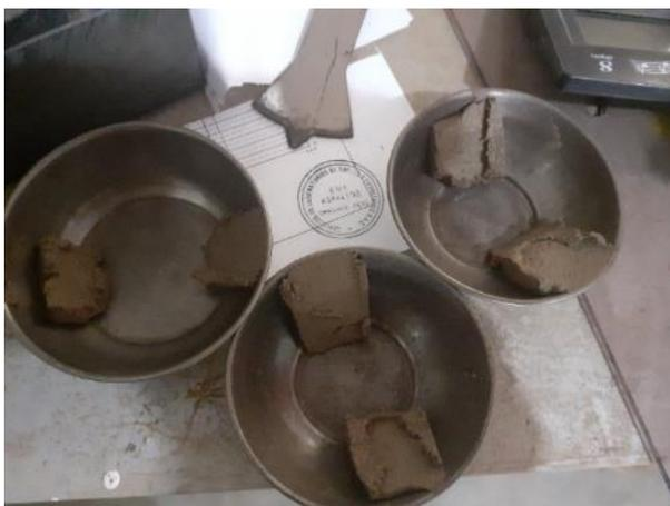
**Figura 32.** Muestras tomadas para determinar el Límite Líquido
