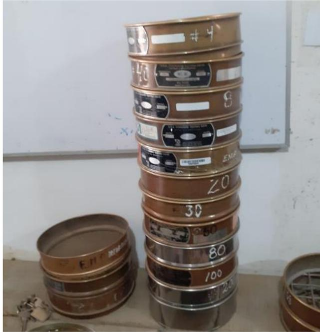
**Figura 27.** Juego de tamices para análisis granulométrico, agregado fino
