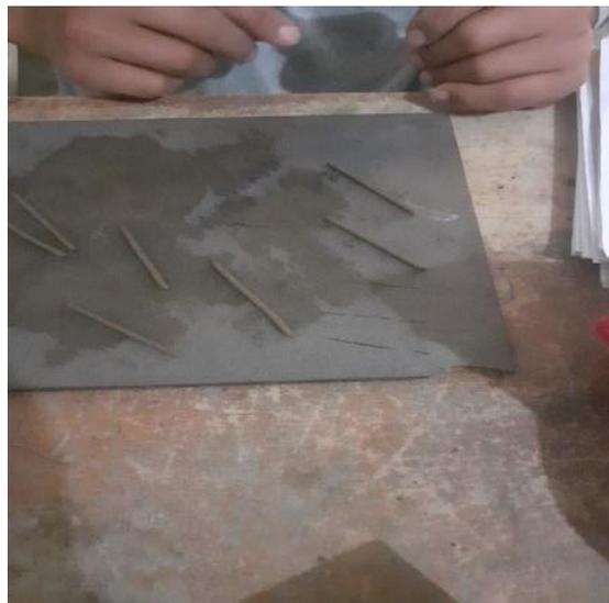
**Figura 34.** Formación de cilindros de diámetro uniforme.
