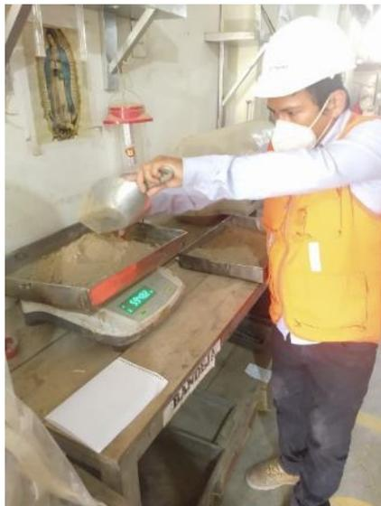
**Figura 36.** Muestra de suelo para ensayo de Proctor modificado
