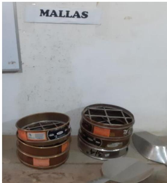
**Figura 25.** Juego de tamices para análisis granulométrico, agregado grueso
