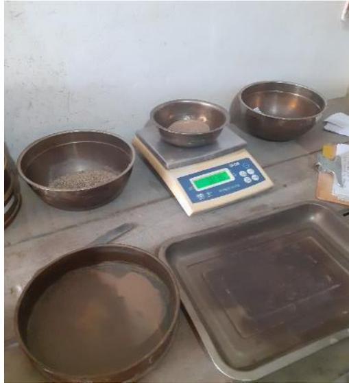
**Figura 23.** Peso de muestra para determinar contenido de humedad
