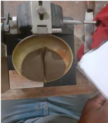
**Figura:** Uso de aparato de Casagrande
