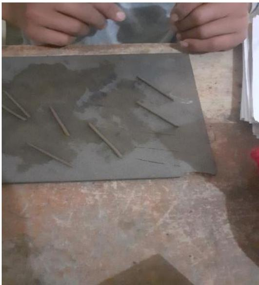
**Figura:** Moldeado de cilindro hasta romperse
