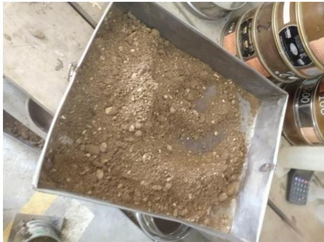
**Figura 37.** Muestra de suelo hidratada, ensayo de Proctor modificado.
