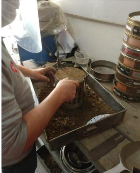
**Figura 40.** Enrazado del cilindro metálico, Proctor modificado
