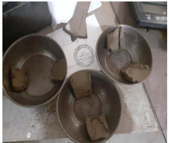
**Figura:** Muestras para determinar el contenido de humedad
