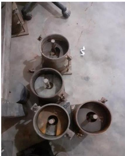
**Figura:** Preparación de cilindros
