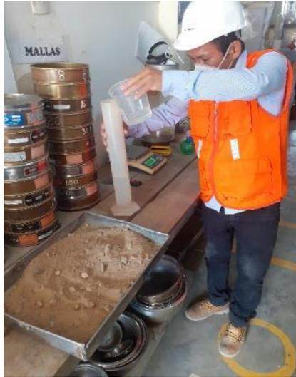
**Figura:** Saturación de la muestra
