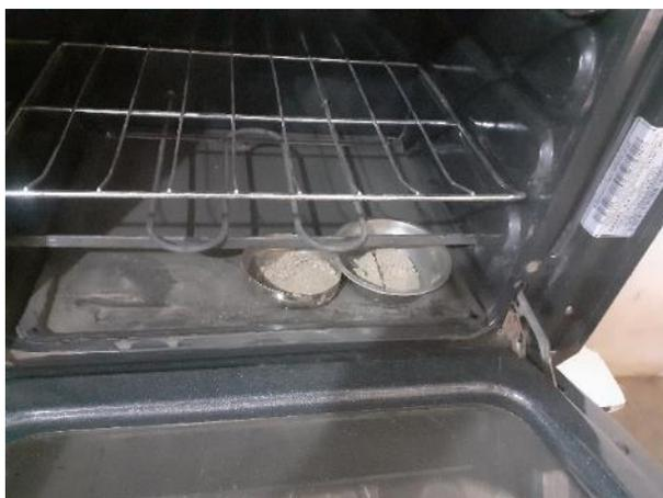
**Figura 46.** Muestras para determinar el contenido de humedad.
