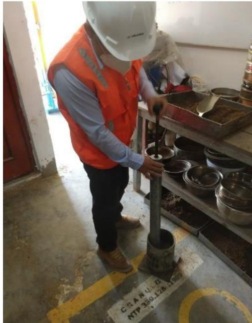
**Figura 39.** Compactación de muestras, Proctor modificado
