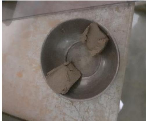
**Figura 33.** Porciones de muestras para ensayo de límite plástico.
