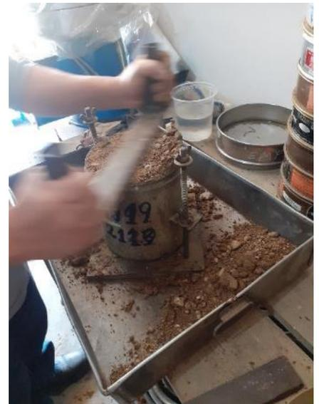
**Figura:** Enrazado de cilindro
