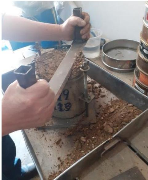
**Figura 47.** Enrazado de cilindro metálico, CBR.
