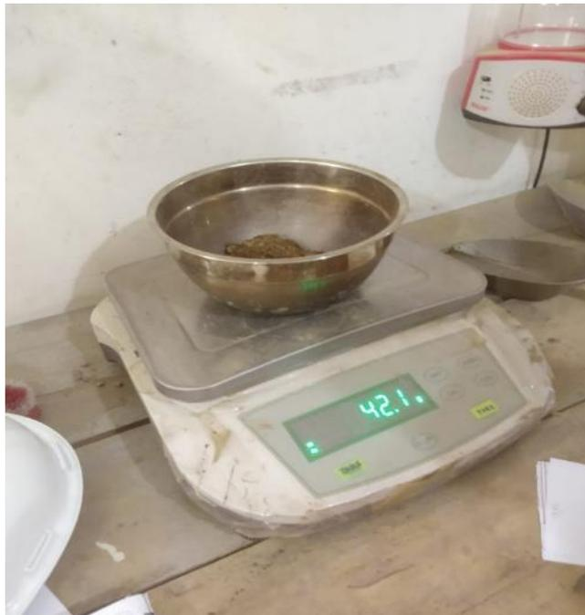
**Figura 28.** Pesado y registro de agregado fino, análisis granulométrico
