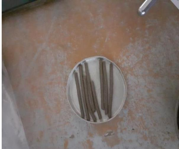
**Figura 35.** Formación de cilindros de diámetro aproximado 3.2mm.
