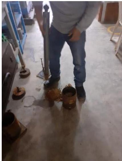
**Figura:** Compactado de muestra
