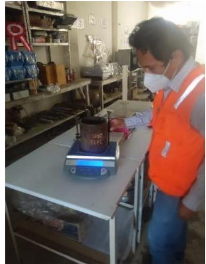
**Figura:** Peso del cilindro
