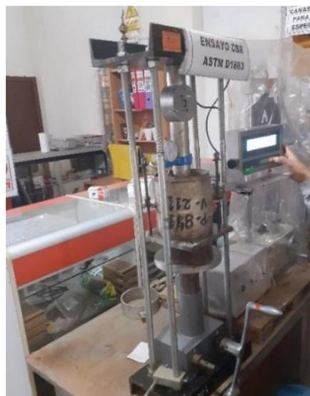
**Figura 50.** Compresión de cilindros para determinar el CBR
