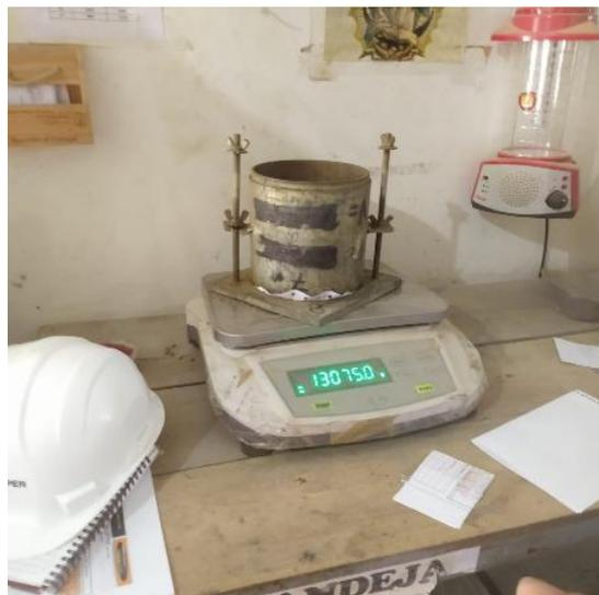
**Figura 38.** Peso del molde para el ensayo de Proctor modificado
