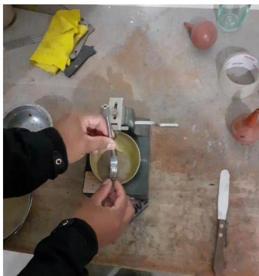
**Figura 30.** Realización de acanalado de la muestra de suelo.
