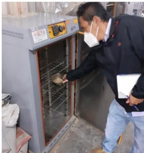
**Figura 24.** Secado del espécimen para hallar su contenido de humedad.
