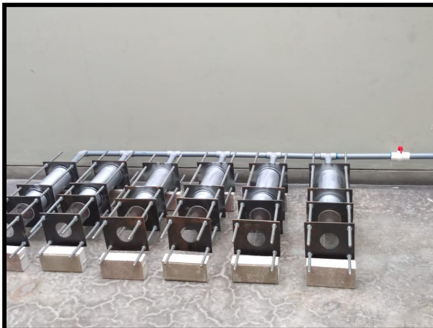
Figura 24. Instalación de tuberías para la conexión de los modelos
