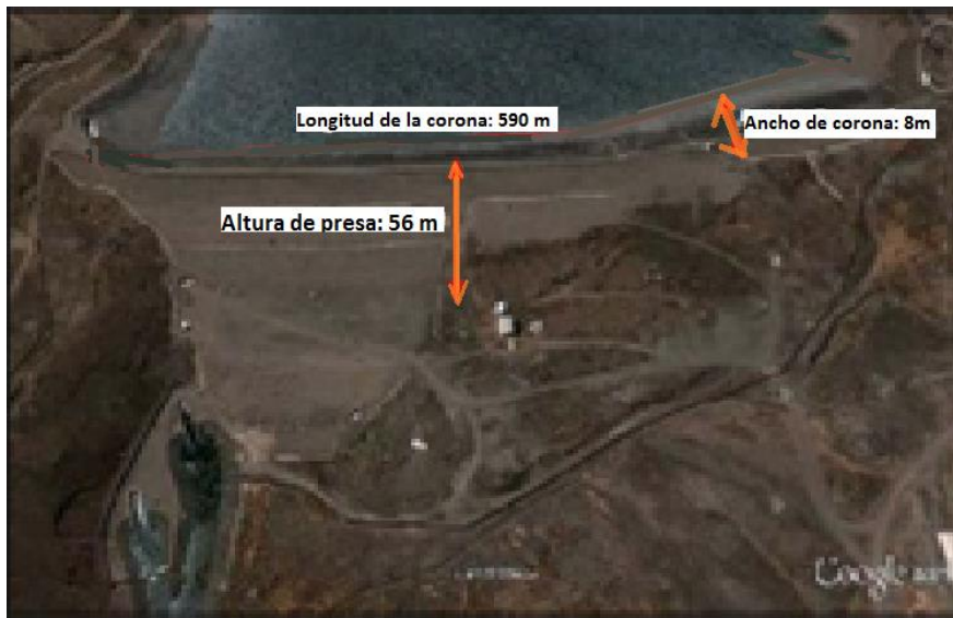
Figura 18. Dimensiones de la presa Yuracmayo
