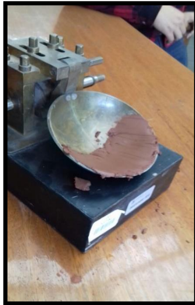
Figura 10. Ensayo de límite líquido de la Muestra N° 1
