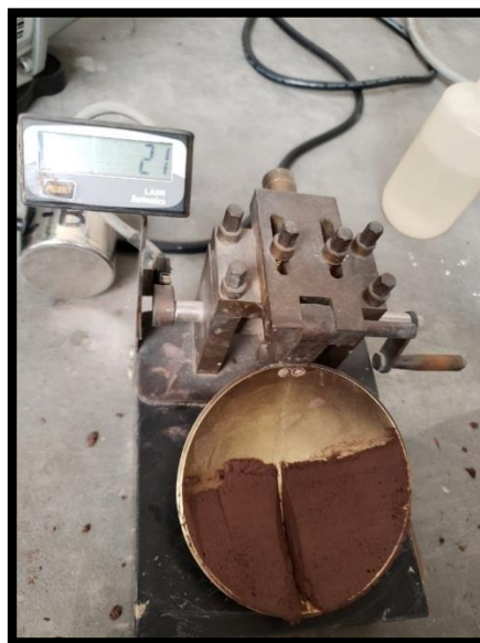
Figura 10. Ensayo de límite líquido de la Muestra N° 2
