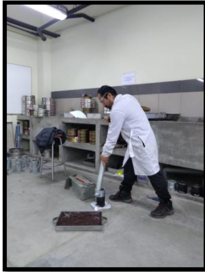
Figura 25. Muestra de suelo N° 1 aplicando el ensayo de compactación en el modelo
