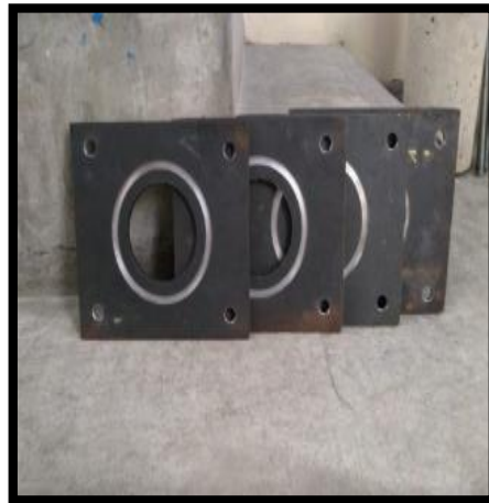
Figura 22. Corte y perforación de las planchas
