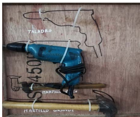
Figura JJJ8. Aplicación de la segunda S por parte de los trabajadores Elaboración: los autores
