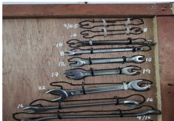
Figura JJJ7. Aplicación de la segunda S por parte de los trabajadores Elaboración: los autores
