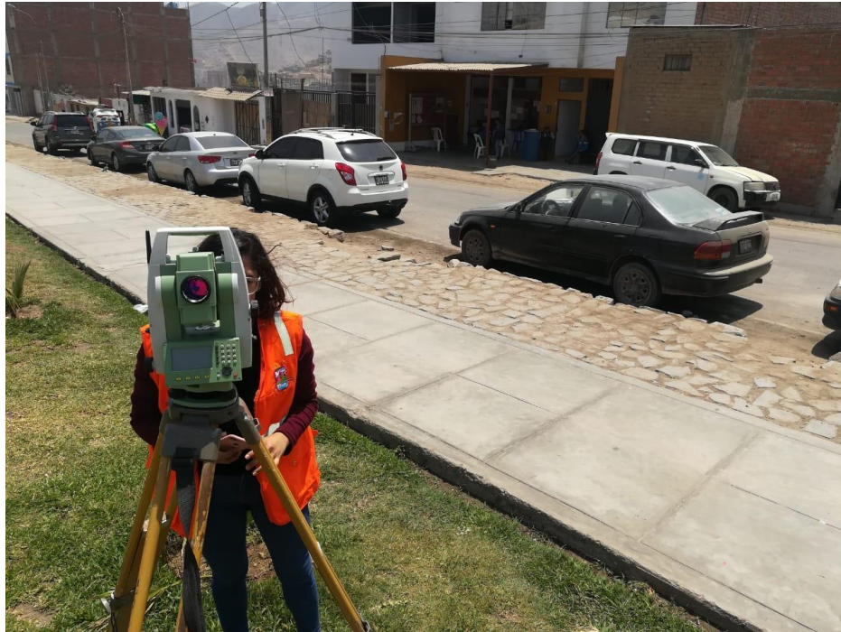
FIGURA 43. Levantamiento topográfico FUENTE: Elaboración propia
