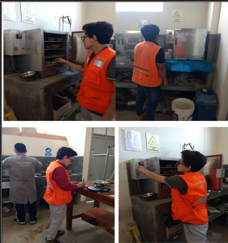
**Fotografía 14:** Se aprecia a los tesisistas realizando el ensayo de contenido de humedad.
