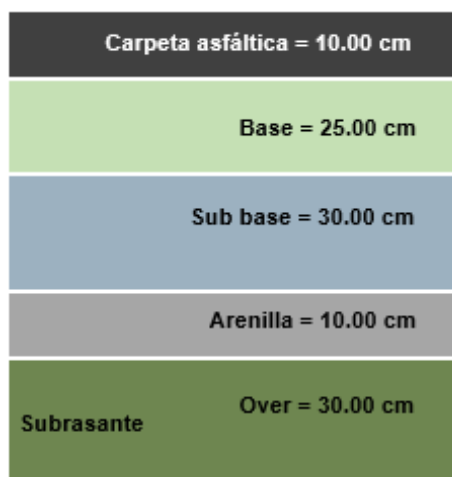
Figura N° 71. Paquete estructural del pavimento flexible – Alternativa 01
