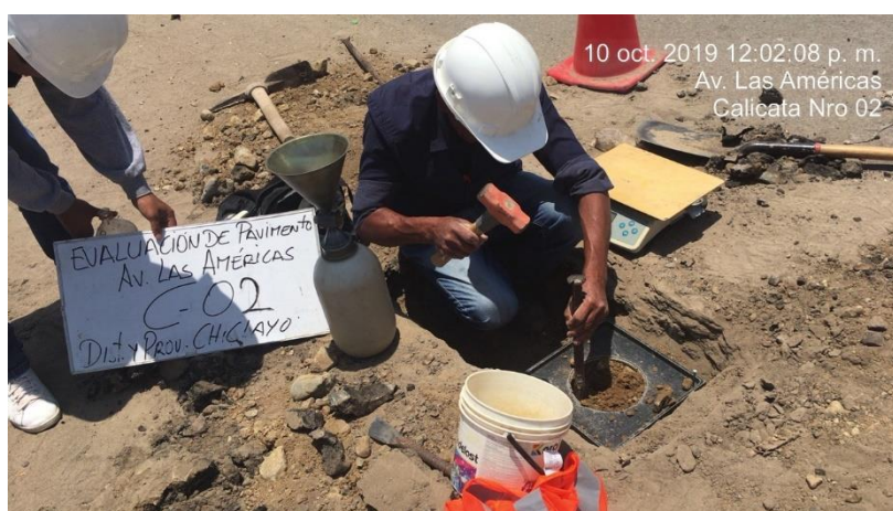
Figura N° 64. Densidad de campo mediante el método cono de arena – Calicata N° 02
