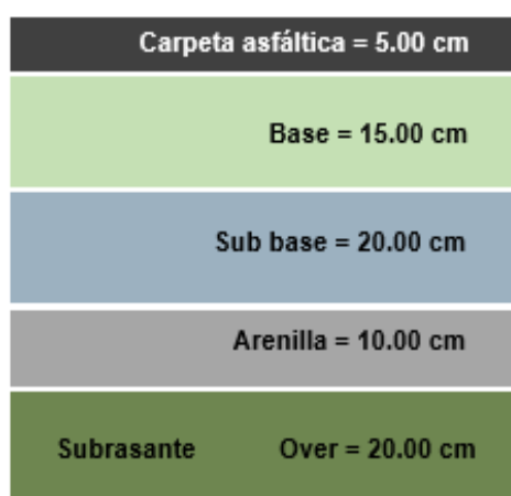
Figura N° 98. Paquete estructural Km 0+050 calzada izquierda – Calicata N° 02
