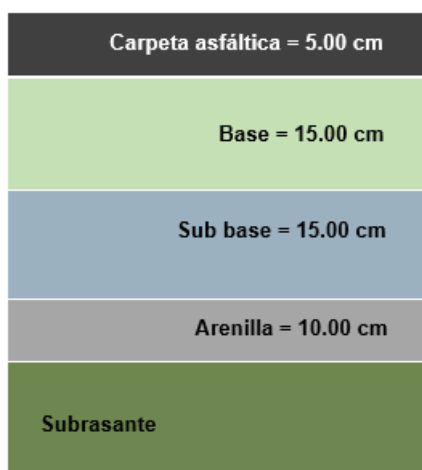
Figura N° 97. Paquete estructural Km 1+053 calzada derecha – Calicata N° 01
