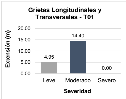
Figura N° 90. Densidad de la falla de Grietas longitudinales y transversales de la Av. Las Américas – Tramo 01 y Tramo 02
