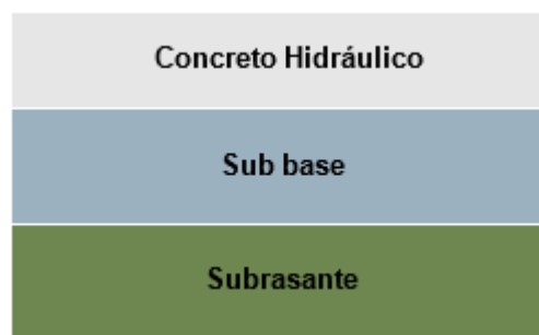
Figura N° 8. Estructura típica de un pavimento rígido
