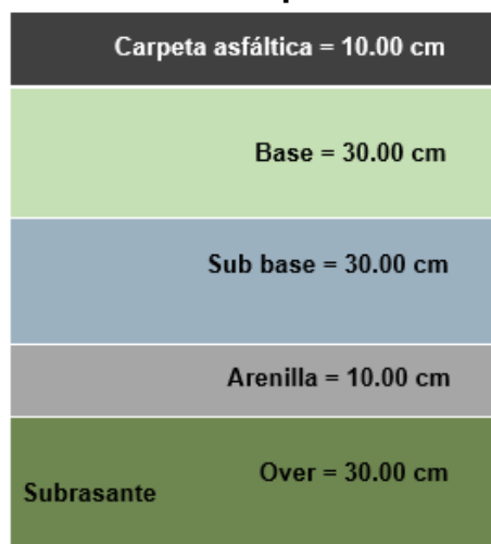
Figura N° 72. Paquete estructural del pavimento flexible – Alternativa 02
