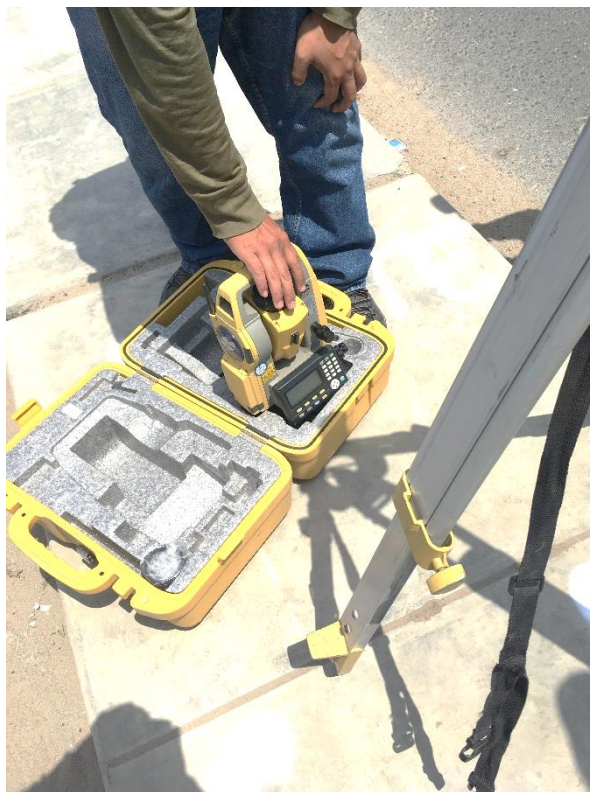
Fotografía N° 2. Estación total usada en el levantamiento topográfico
