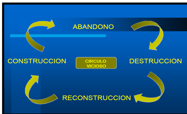
Figura N° 7 Círculo vicioso de una carretera sin una adecuada conservación
