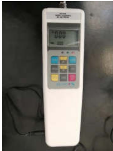
Figura 77: Digital Force Gauge Modelo FH 1K. Fuente: Laboratorio de la Facultad de Zootecnia
