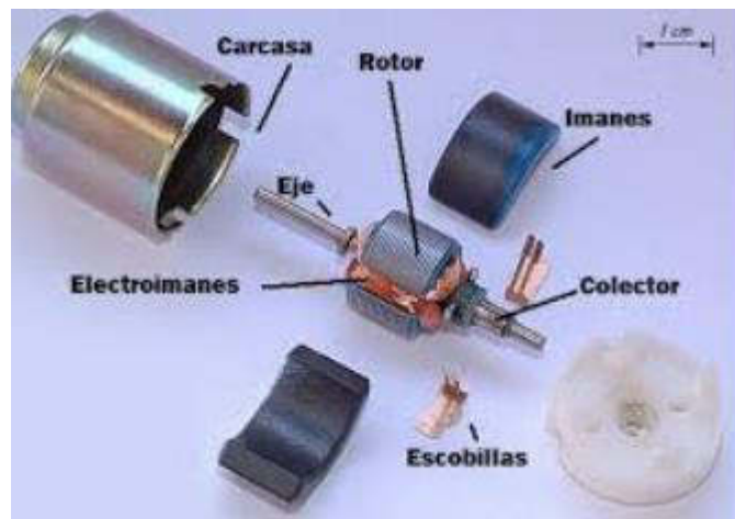
Figura 32: Partes de un motor DC Fuente: Geekbotelectronics.com
