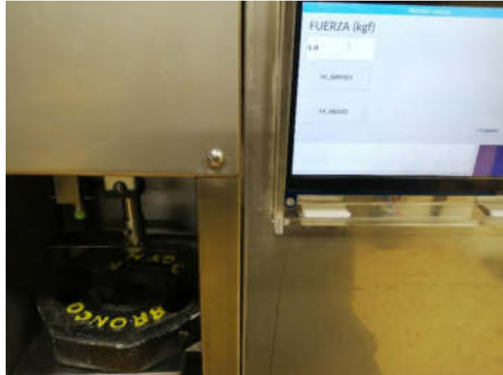
Figura 76: Pesa de 3 kg calculado en el Prototipo. Elaboración: Los autores
