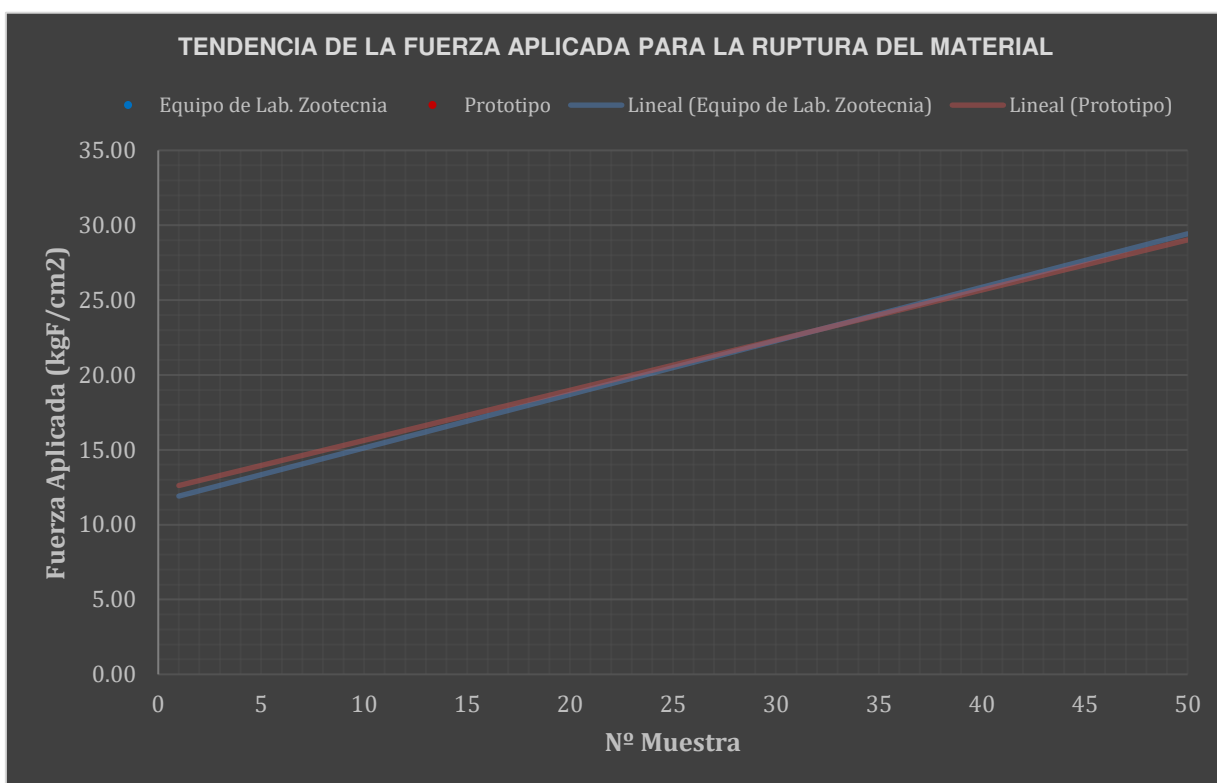
Figura 82: Tendencia de la fuerza aplicada para la ruptura del material Elaboración: Los autores
