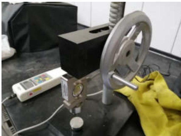
Figura 78: Estructura para realizar el cálculo de resistencia ósea compatible con el Digital Force Gauge Modelo FH 1K. Fuente: Laboratorio de la Facultad de Zootecnia
