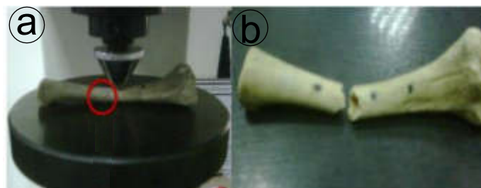
Figura 11: a) Prueba de compresión en tibia de pollo b) Resultado del ensayo. Fuente: IEEEExplore.ieee.org
