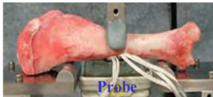
Figura 18: Prueba de flexión de tres puntos utilizando una tibia porcina. Fuente: IEEExplore.ieee.org
