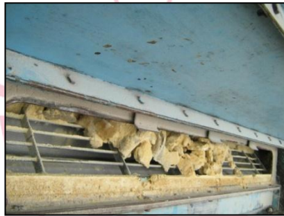
Figura 52 - Estado de los rodillos trituradores
