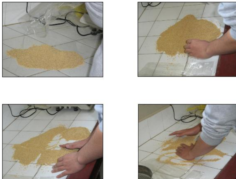
Figura 41 - Forma de uniformizar muestras por el método del cuarteo Elaborado por los autores
