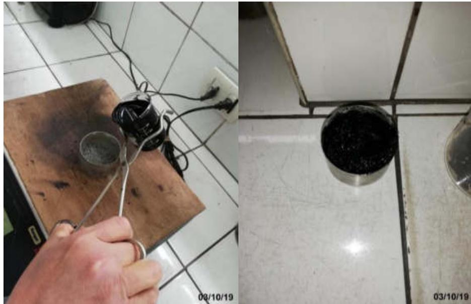
*Figura 51.* Mezcla de ligante bituminoso con el agregado fino
