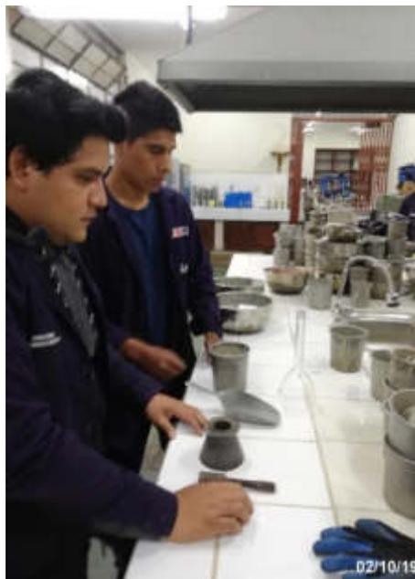
*Figura 40.* Extracción de arena de pavimento para cuartear
