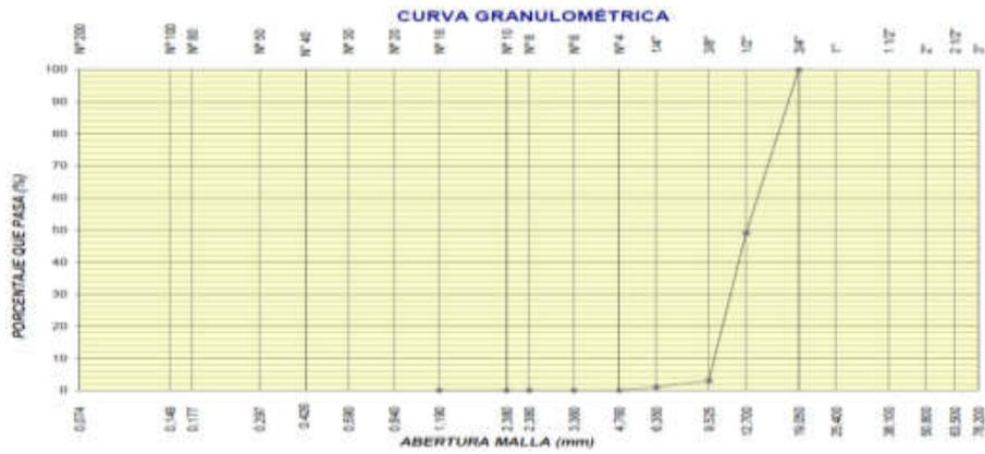
Figura 63. Curva granulométrica del agregado grueso Huso 67
