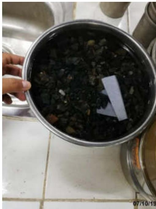
*Figura 24.* Saturación en agua por 16 horas
