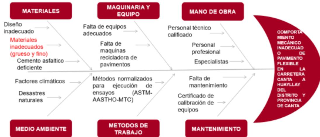
Figura 3. Diagrama causa–efecto del comportamiento mecánico inadecuado de pavimento flexible en la carretera Canta a Huayllay del distrito y provincia de Canta
