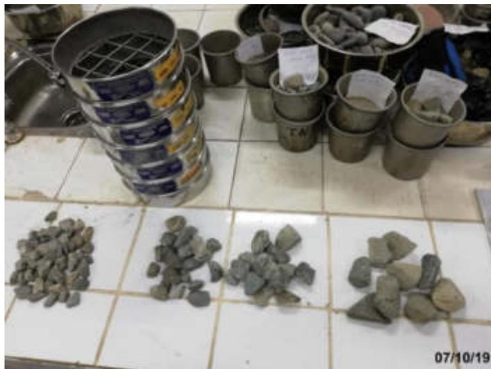
*Figura 28. Separación del agregado grueso de acuerdo a los tamices*
