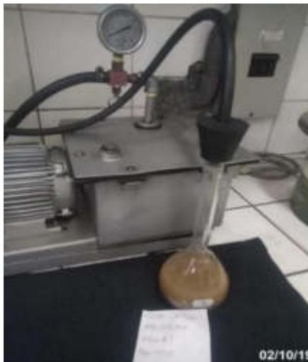
*Figura 44.* Extracción del aire con la bomba de vacío
