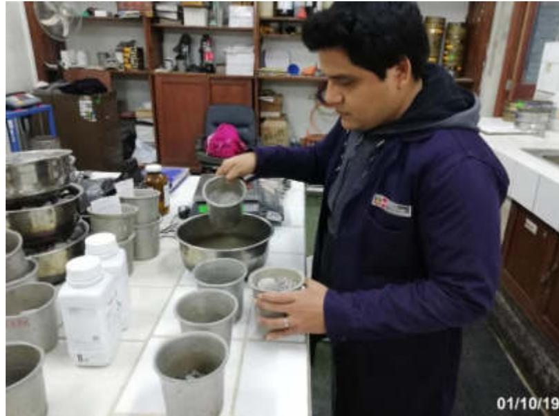
*Figura 39. Peso final para arena de pavimento*
