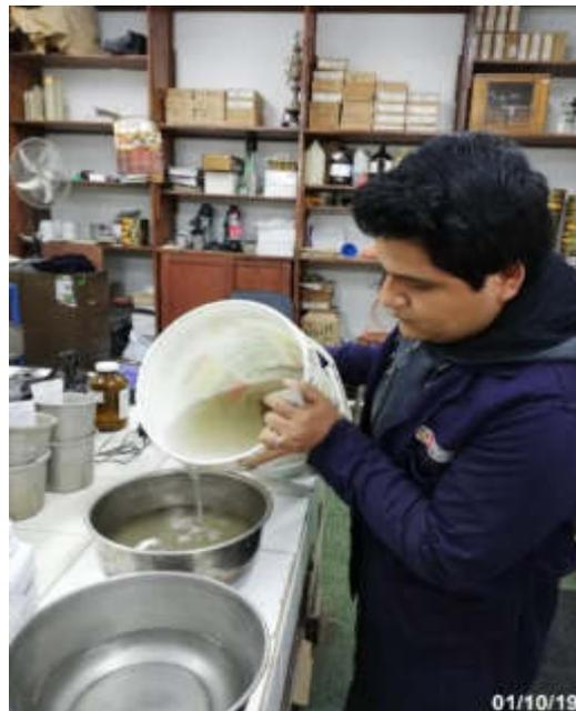
*Figura 38.* Mezcla de sulfato de magnesio con la arena de pavimento
