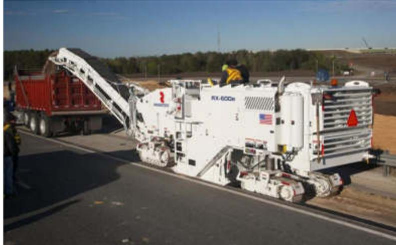
*Figura 9.* Extracción de carpeta asfáltica
