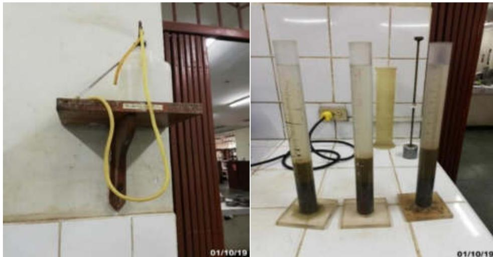
*Figura 42. Líquido Stock y frascos de ensayos con material fino y solución*
