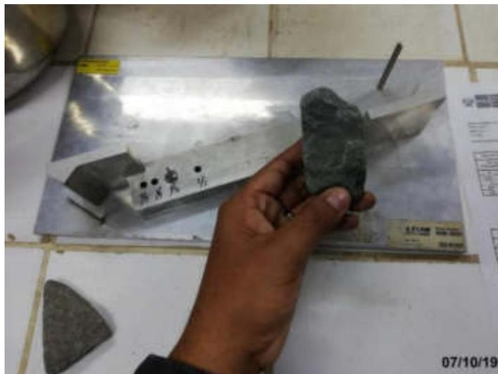
Figura 30. Agregado grueso de una a dos caras de fractura
