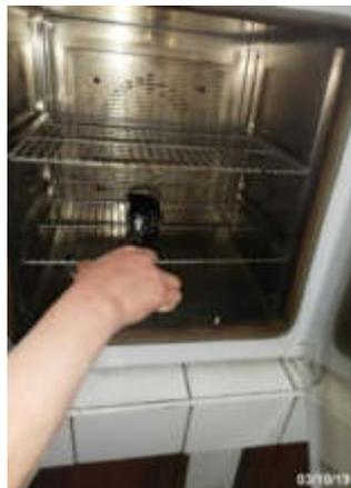
*Figura 50.* Horno a 110°C, sacando el ligante bituminoso
