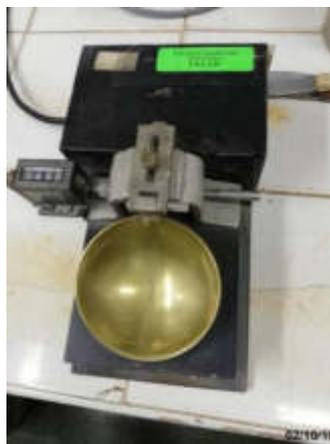
*Figura 45. Máquina Cuchara Casagrande*
