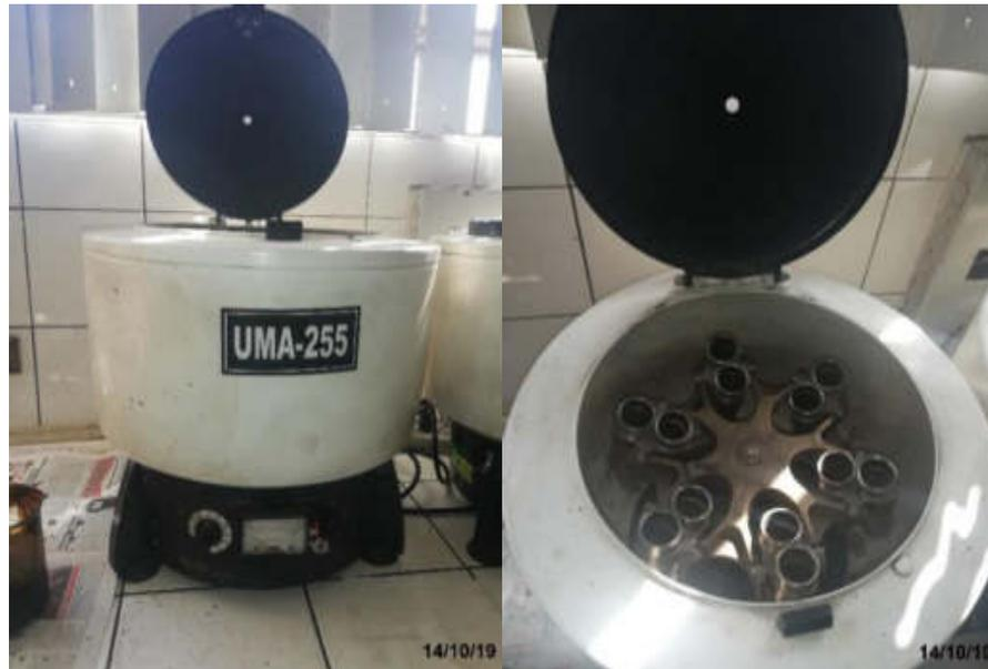
Figura 18. Máquina de centrifugado para fino (reciclado)
