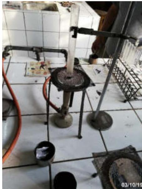
*Figura 52.* Ebullición de ligante bituminoso con agua destilada
