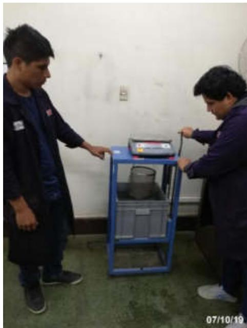
*Figura 26. Máquina de peso específico*
