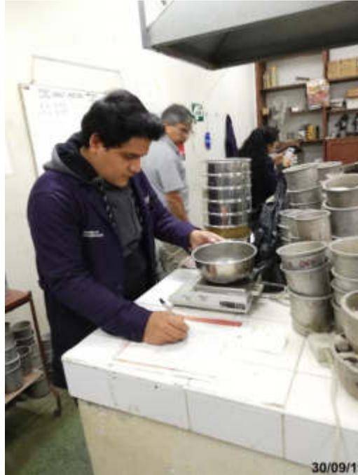
Figura 36. Recolección de datos en el tamizado para agregado fino
