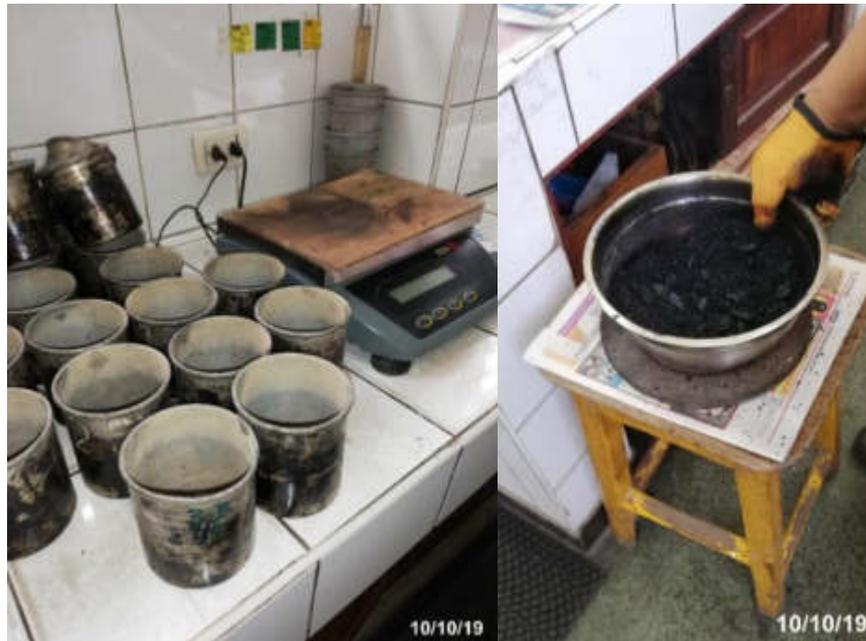
*Figura 56.* Proceso de elaboración de briquetas
