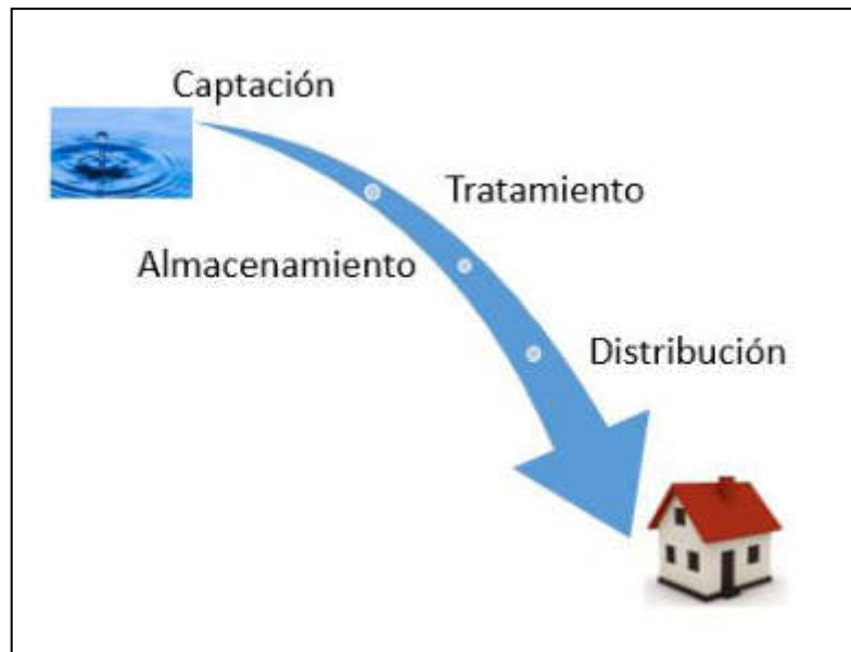
Figura 19: Proceso de abastecimiento de agua potable
