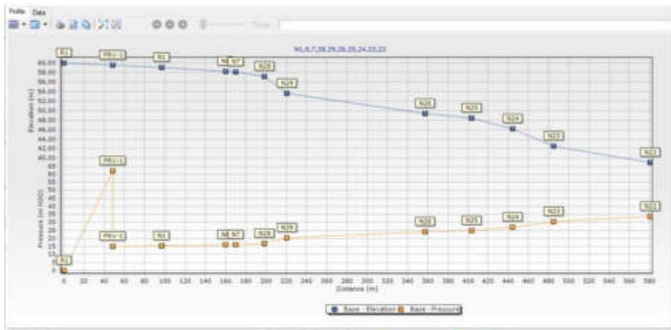
Figura 28: Perfil de la presión vs. la elevación del primer tramo
