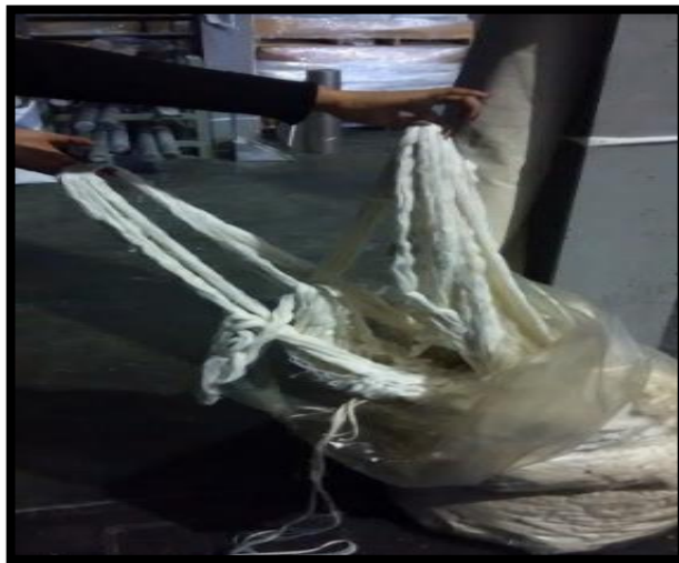
Figura 256. Una vez terminado el proceso de engomado, se procede a abrir la bolsa de hilos para realizar el control de calidad correspondiente.
