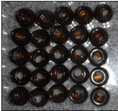
Figura 8. Muestras sumergidas en agua destilada antes de toma de color inicial
