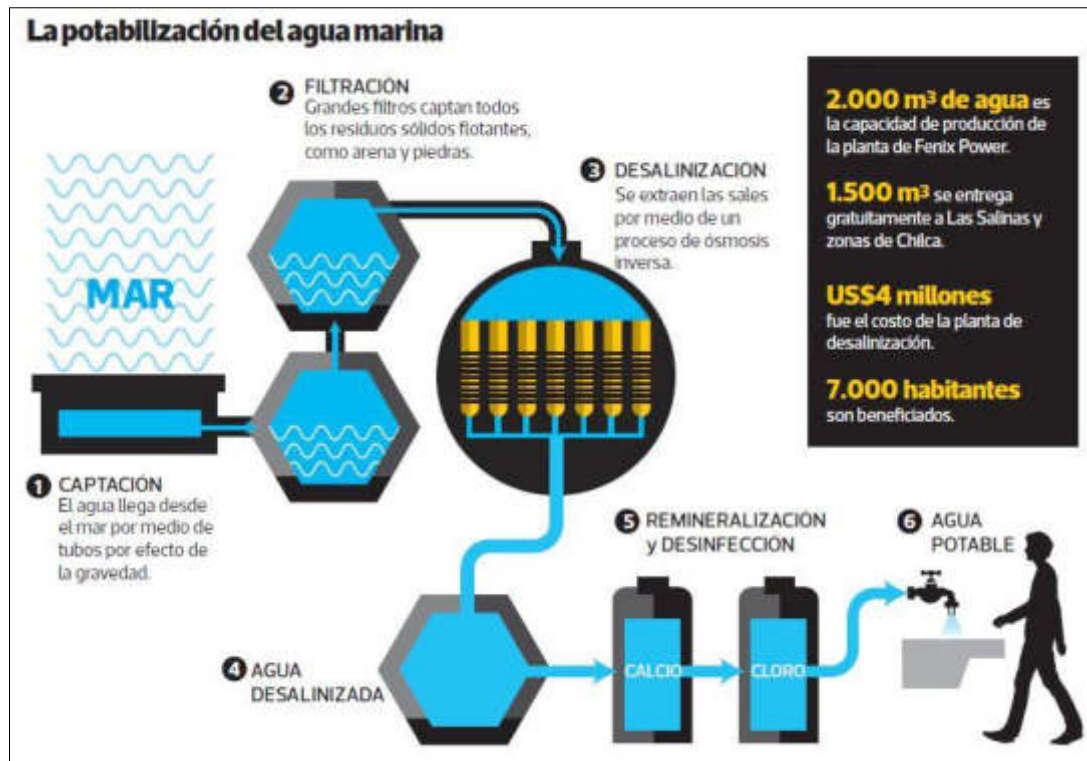
Figura 10. Potabilización del agua marina
